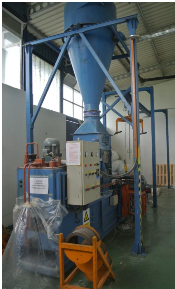
Слика 2.1 Постојећа масина за балирање
