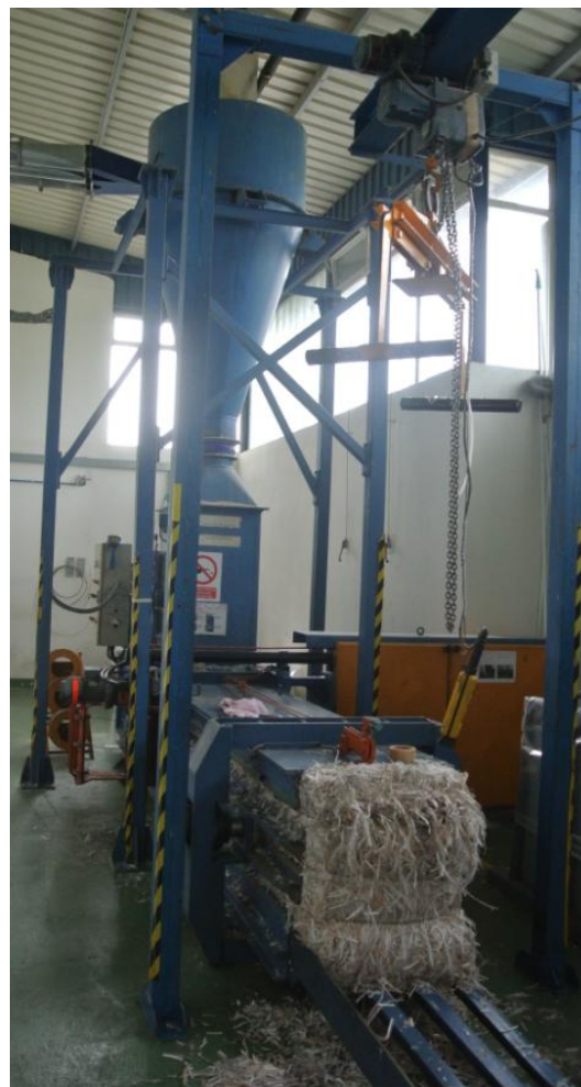
Слика 2.1 Постојећа масина за балирање
