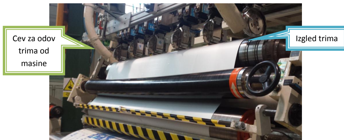
Слика 2.6 Приказ настанка трима на машини
