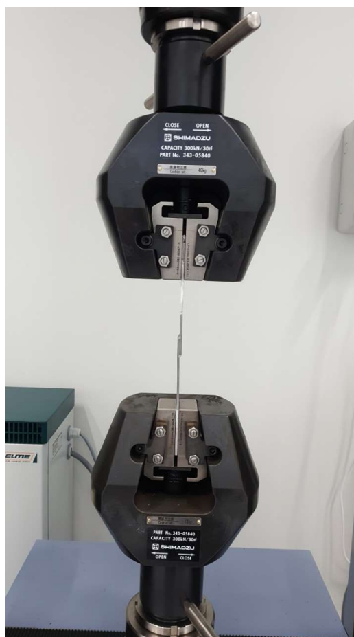
Слика 5.1.1. Испитивање затезањем на глодалици [7]
