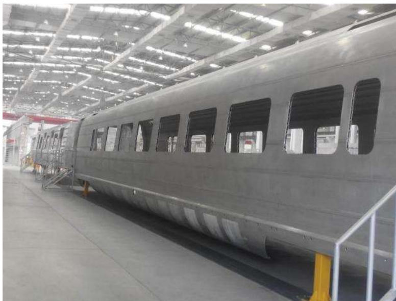
Слика 3.2.1. Шасија шинског возила од алуминијума [6]
