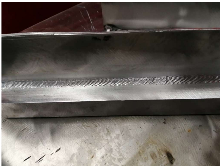
Слика 3.4.5. Успешно заваривање MIG поступком [6]
