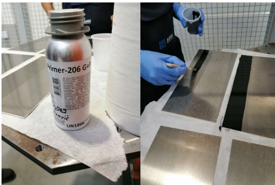
Слика 4.5.3. Наношење прајмера на подлогу [6]
