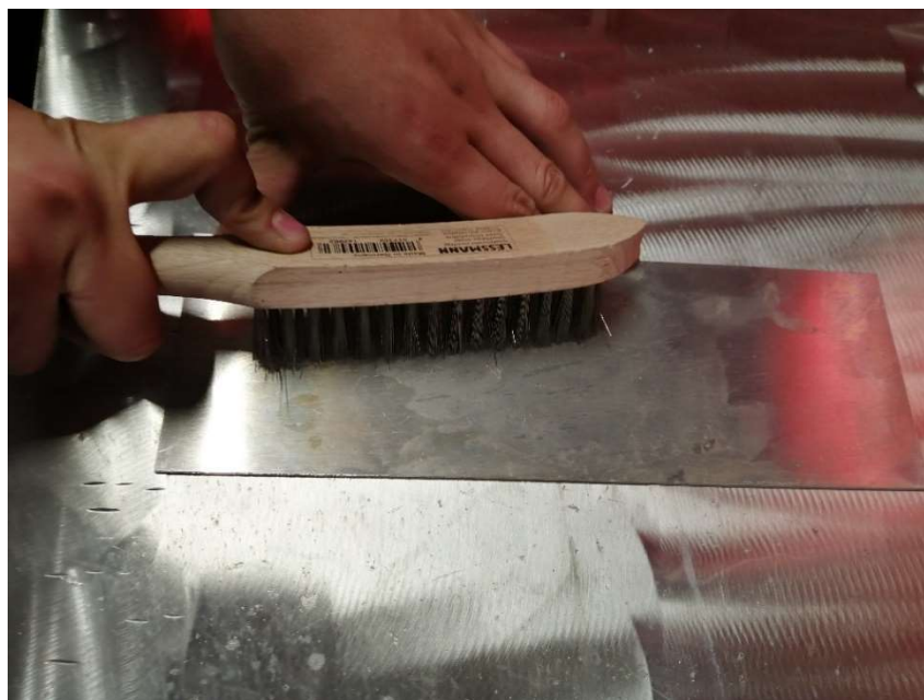
Слика 3.3.1. Припрема плоче за заваривање [6]
