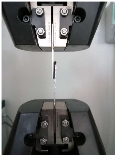
Слика 5.2.4. Узорак постављен у чељусти кидалице [7]
