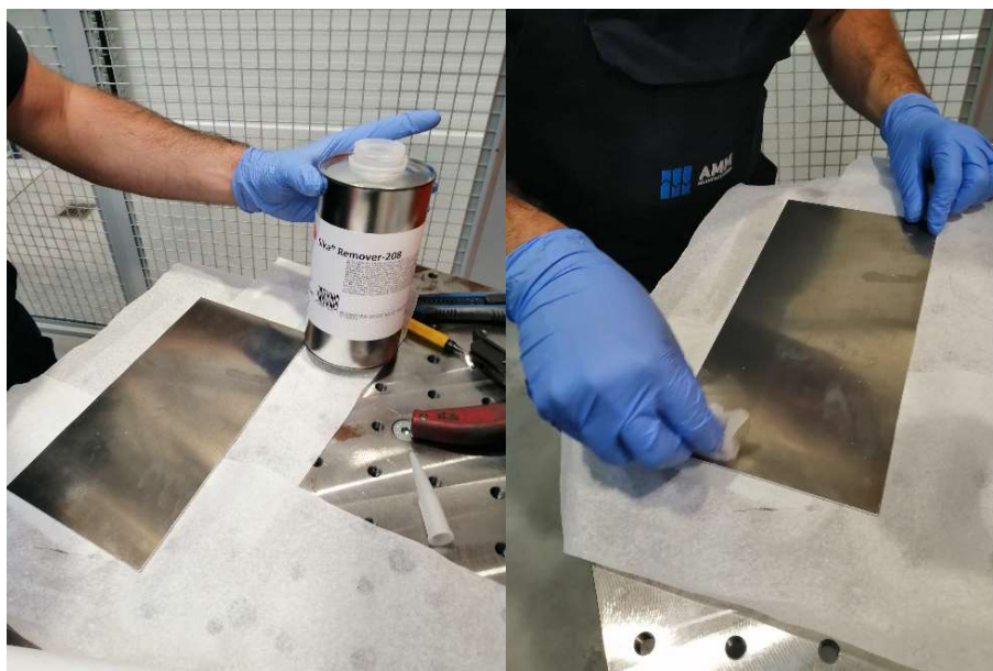
Слика 4.5.1. Уклањање нечистоћа са алуминијума [6]
