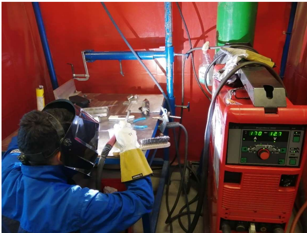
Слика 3.4.2. Заваривање TIG-ом у производним условима [6]
