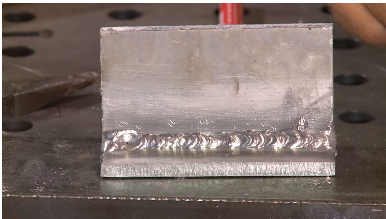
Слика 3.4.6. Узорак урађен РЕЛ поступком [6]
