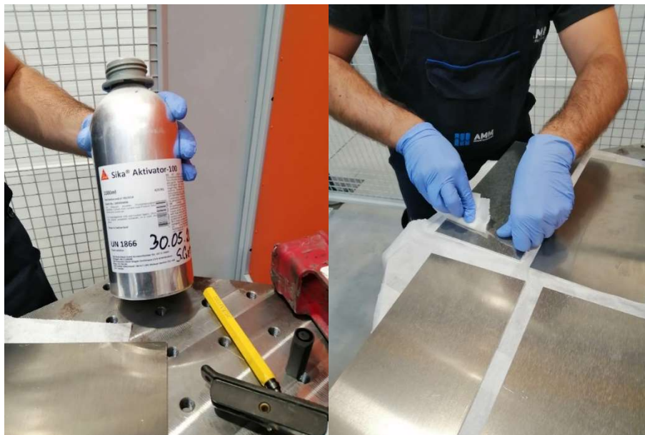
Слика 4.5.2. Наношење активатора на подлогу [6]
