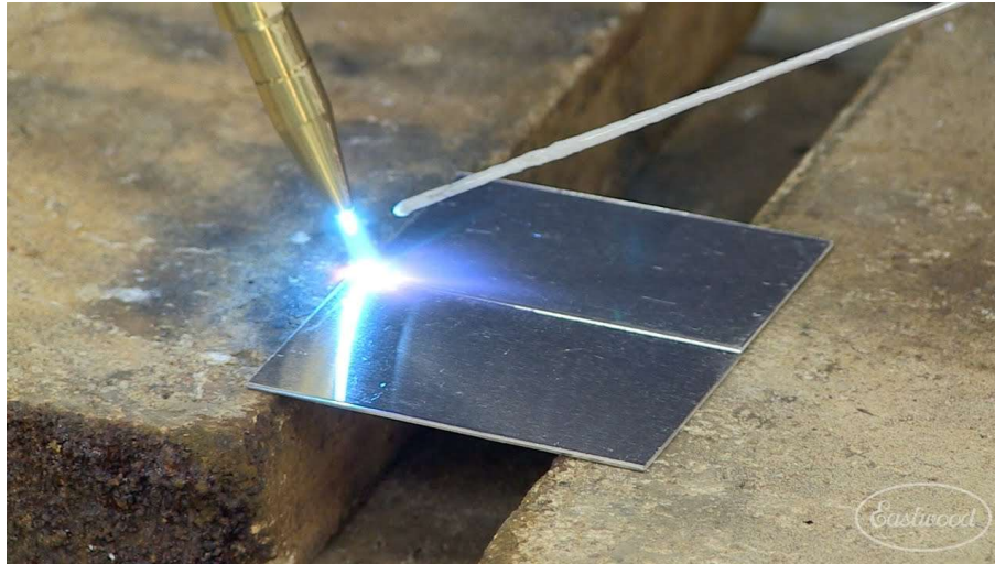
Слика 3.4.7. Заваривање алуминијума гасним поступком са обложеном електродом [6]
