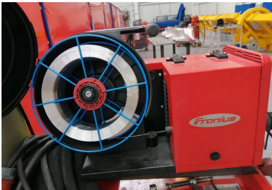
Слика 3.5.1. Додатни материјал у додавачу Fronius-овог апарата за заваривање [6]
