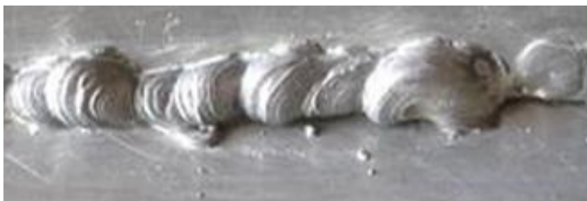
Слика 4.7 Изглед шави добијен обложеном електродом [8]
