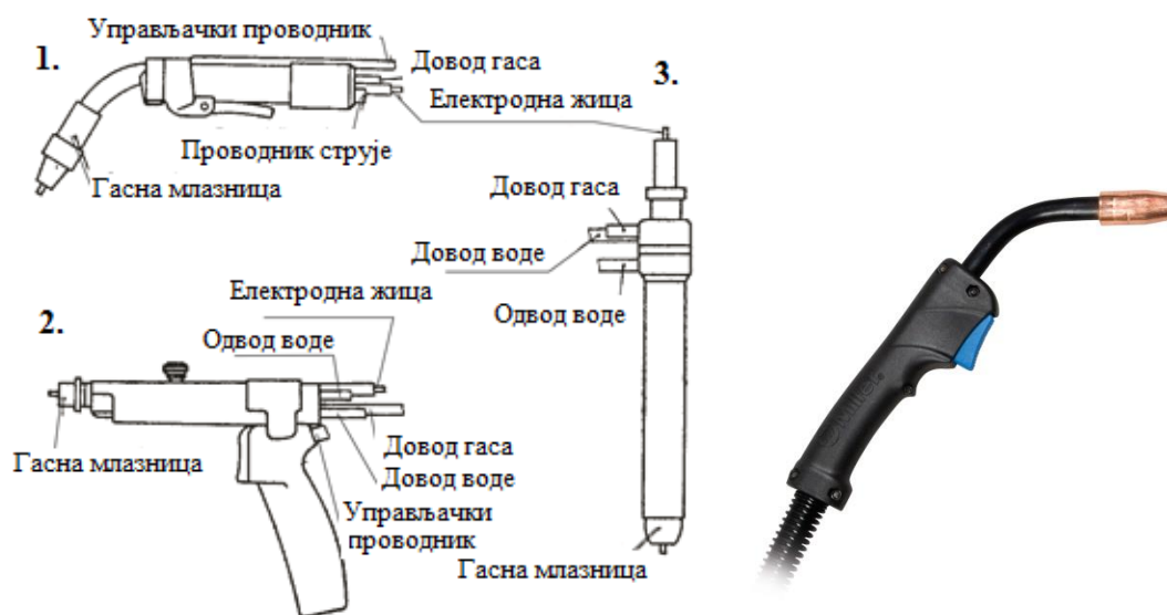
Слика 4.19 Облици пиштоља за MAG/MIG поступак заваривања – лево и заваривачки пиштољ марке „Miller“ за MIG поступак - десно [29]
