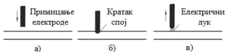
Слика 4.3 Успостављање електричног лука код РЕЛ заваривања [17]
