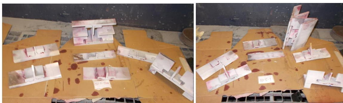
Слика 5.12 Радне пробе заваривача – AP 50-7-1/2016 и AP 50-12-1/2016
