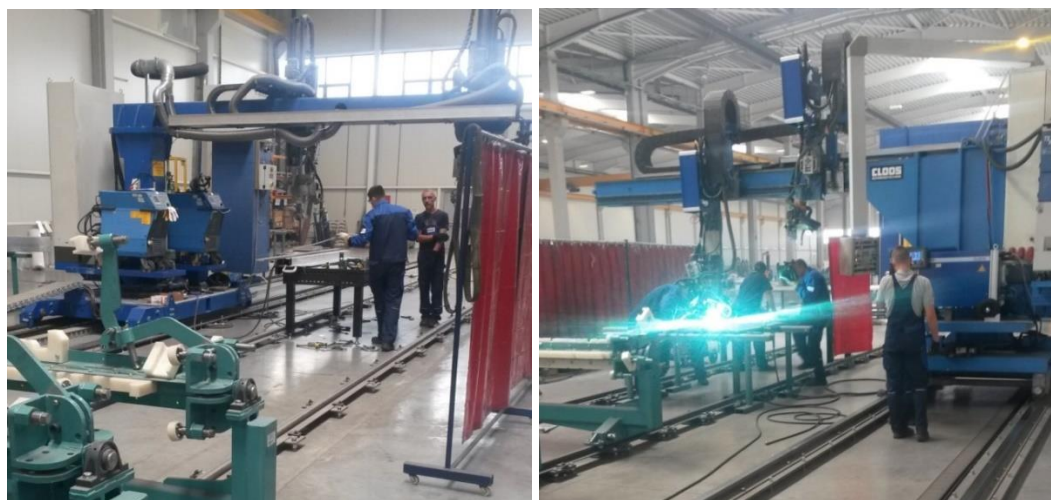
Слика 5.6 Аутоматизовано заваривање (MIG, TIG поступци заваривања)
