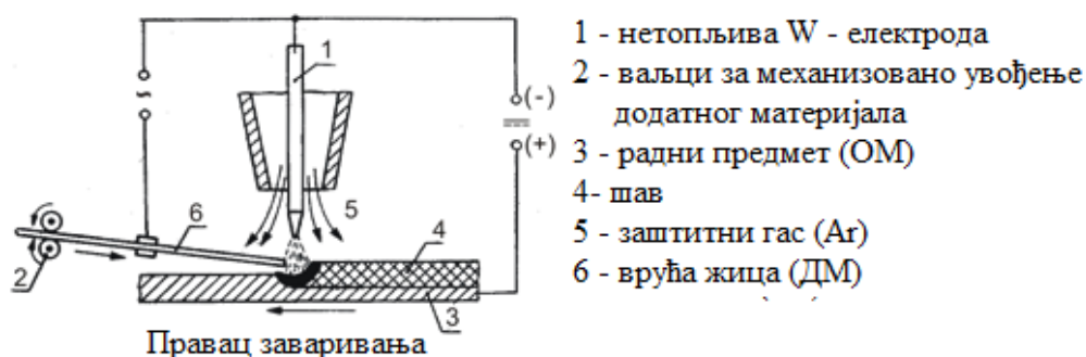
Слика 4.11 Схема механизованог TIG - заваривања врућом жицом [19]
