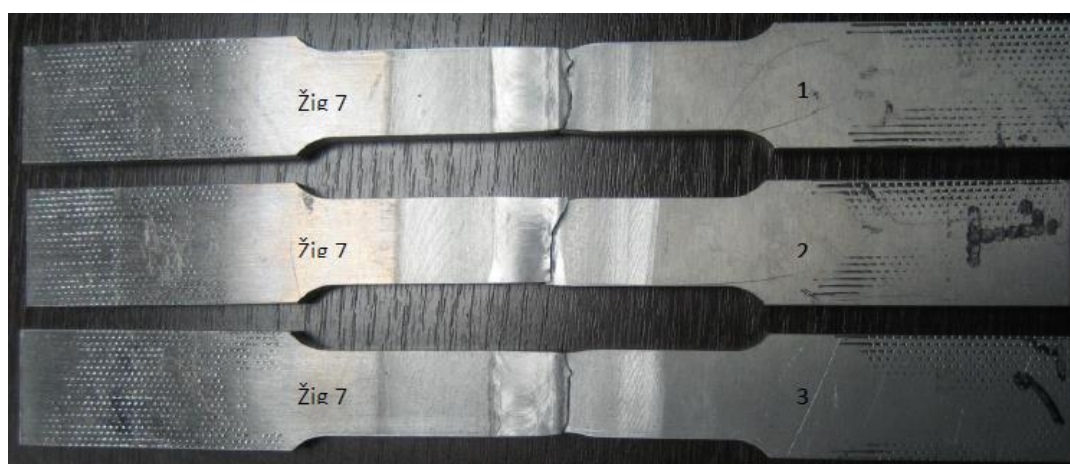
Слика 5.7 Изглед испитиваних узорка (епрувета) после испитивања затезањем
