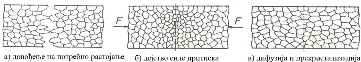
Слика 1.4 Фазе образовања споја притиском [1]
