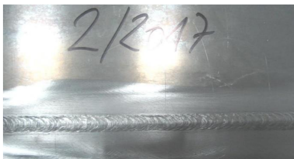
Слика 5.7 Узорак 2/2017 намењен за визуелно испитивање
