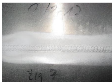
Слика 5.8 Узорак на коме је нането средство намењено за испитивање пенетрантима
