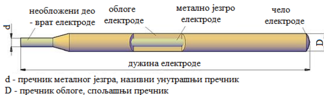
Слика 4.5 Обложена електрода код REL методе заваривања [18]
