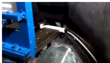
Слика 12. Преса у тренутку савијања поцинковане жице
