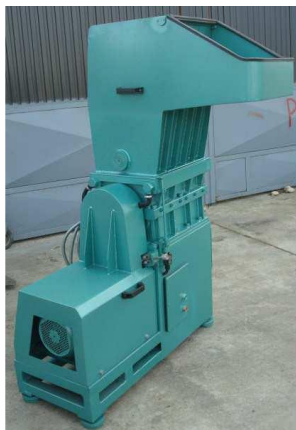
Слика 7. Млин за млевење отпадне пластике марке ELDON [1]
