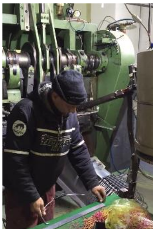
Слика 13. Оператер за пресом контролише примерак жичане ручке
