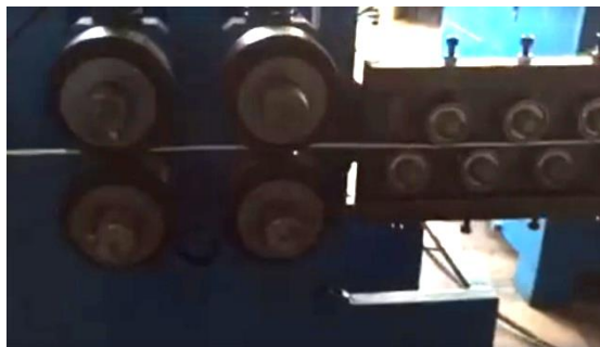
Слика 10. Ваљци у процесу исправљања поцинковане жице
