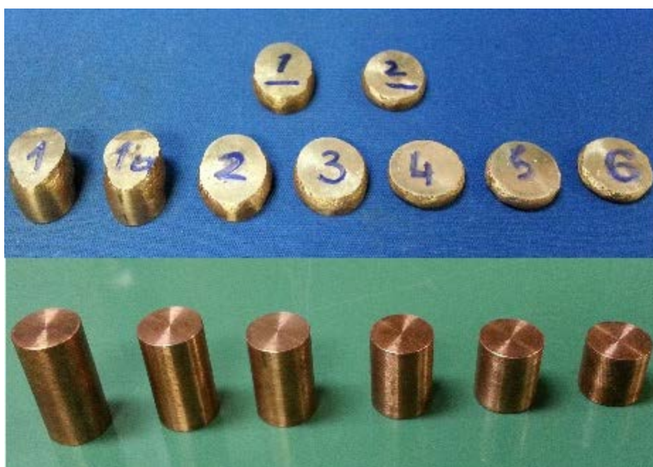
Слика 4.15 Изглед серије епрувета за тест по Шофману пре и после сабијања [6]
