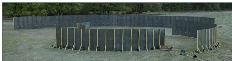
Слика 10.3. Распоред елемената при распрскавању ради одређивања вероватноће погађања [3]
