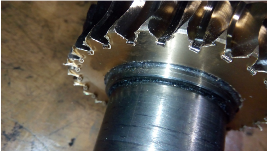
Слика 51. Остаци струготине на пужном точку
