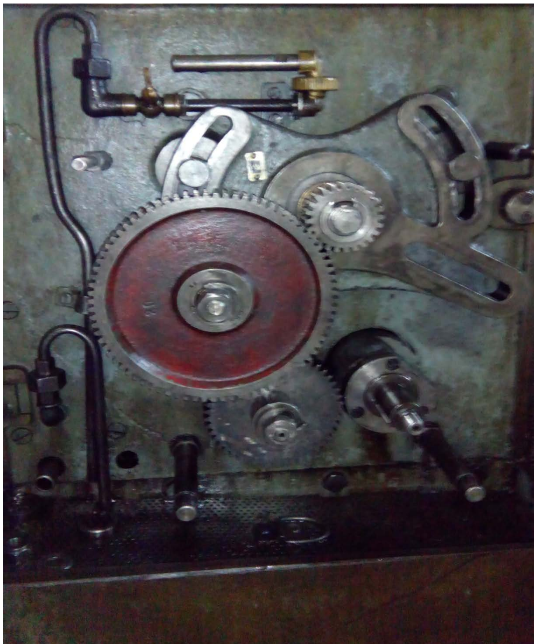
Слика 42. Преноси однос при изради зупчаника са спиралним зупцима
