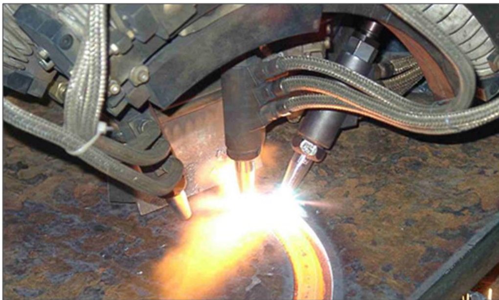
Слика 16. - Окси - гориве CNC машине за заваривање и сечење косих делова
