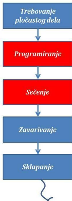
Слика 35. - Дијаграм редоследа производних операција
