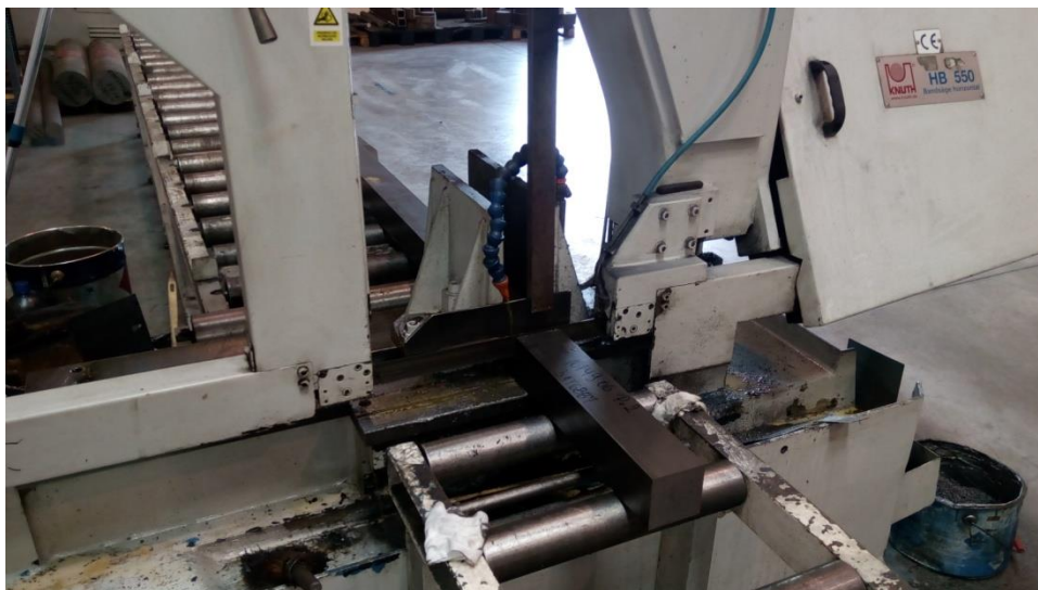
Слика 20. – Сечење флахастог материјала
