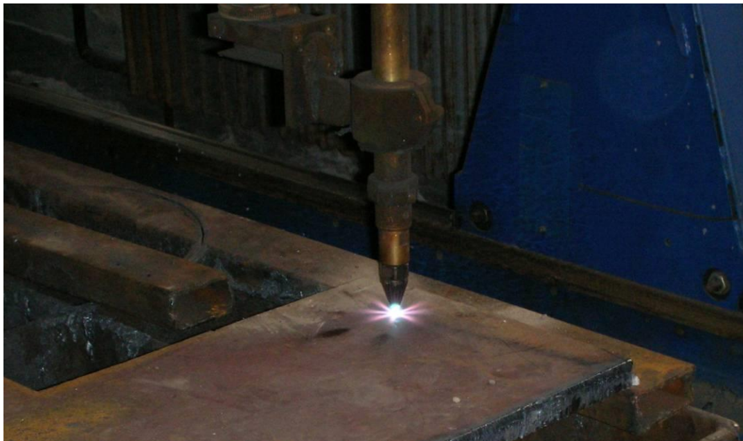
Слика 32.- Приказ процеса предгревања
