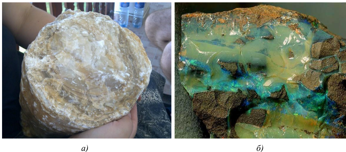
Слика 4.2 Оксид силицијума ( \text{SiO}_2 ) који је присутан у бокситима и може бити слободан као а) кварц или б) опал [10,11]
