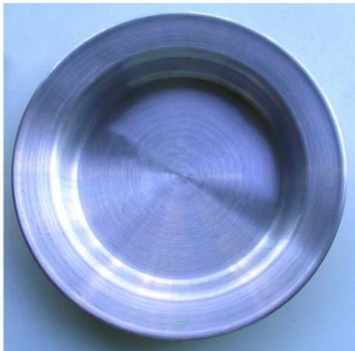
Слика 6.10 Алуминијумски тањир добијен пластичним деформисањем на хладно (операција дубоког извлачења) [14]
