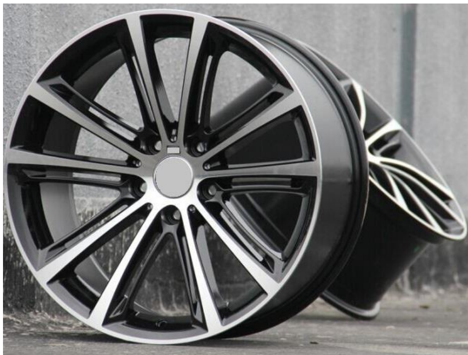
Слика 6.1 Фелне аутомобила израђене од дуралуминијума [12]
