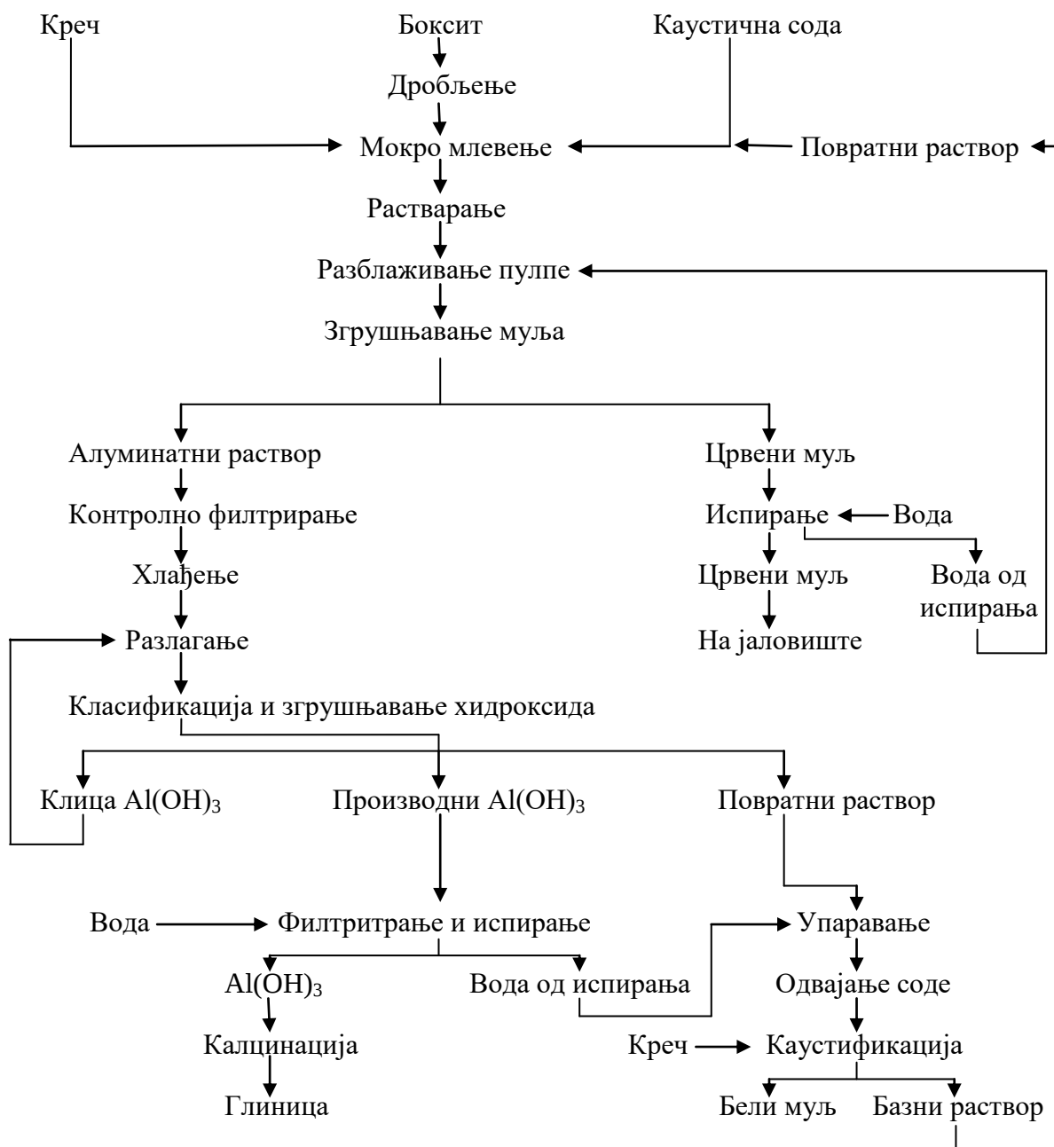
Слика 4.1 Принципијелна технолошка схема Бајеровог поступка [9]
