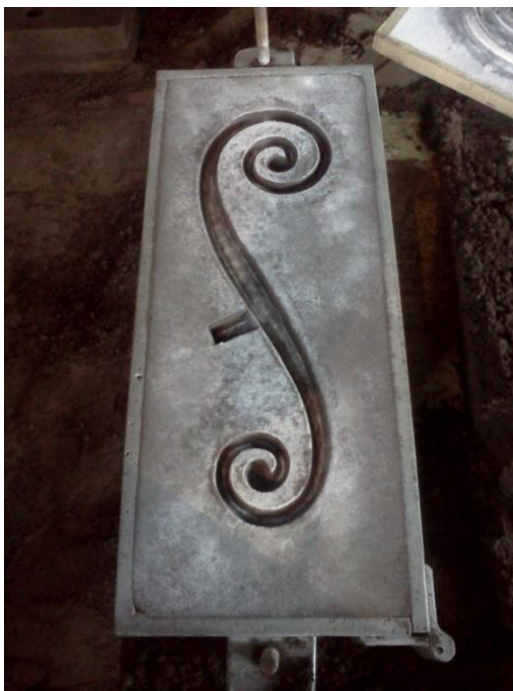
Слика 1.1 Калуп за ливење једног од различитих облика од алуминијума [2]
