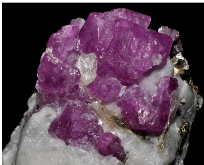
Слика 2.2 Безводни оксид алуминијума-корунд [5]
