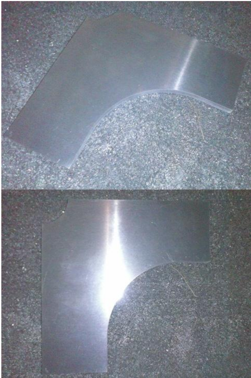
Слика 4.6. Изглед држача после обраде на ласеру
