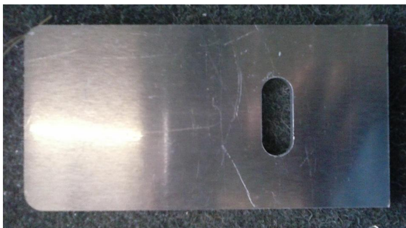
Слика 4.4. Изглед држача после обраде на ласеру
