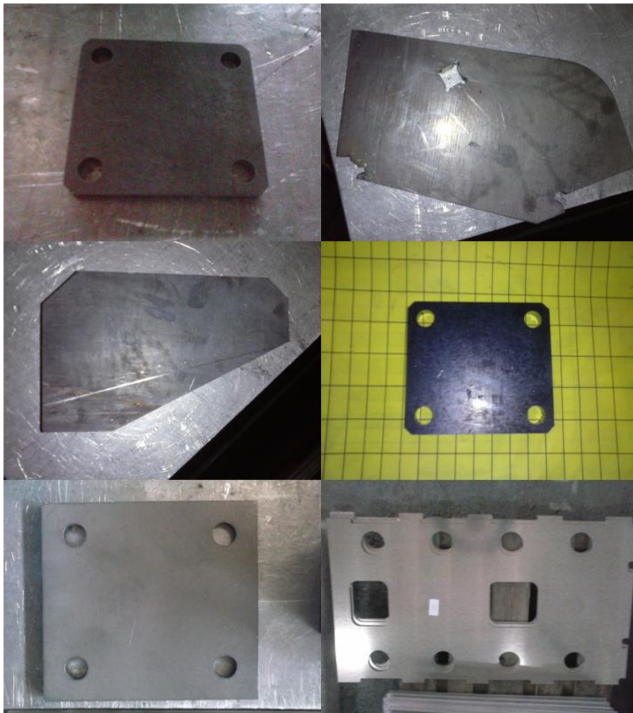
Слика 4.9. Делови израђени на ласерској машини TruLaser L4030S
