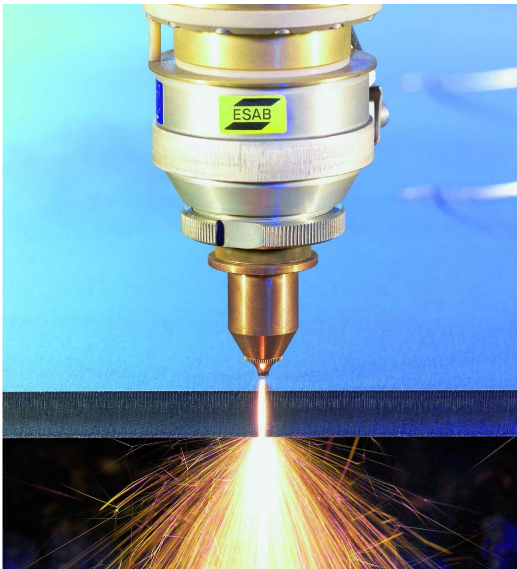
Слика 2.22. Сечење ласером [4]
