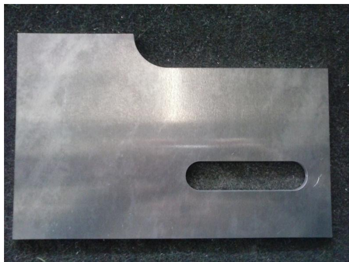
Слика 4.2. Изглед дела за ојачање после обраде на ласеру
