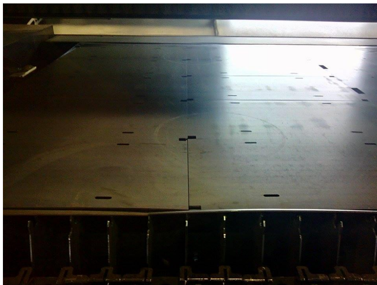
Слика 41. Исечена табла применом опције Homocutting-a
