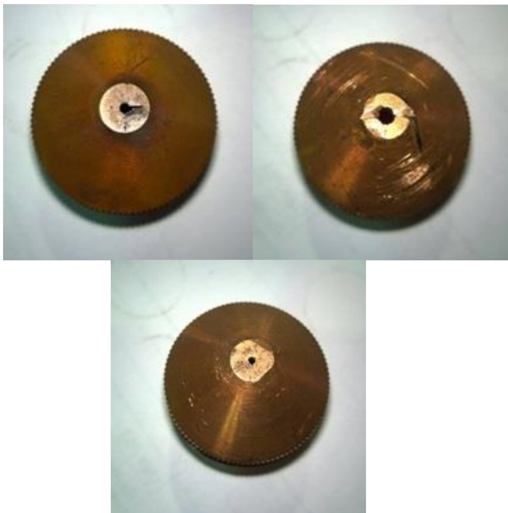
Слика 44. Оштећене дизне
