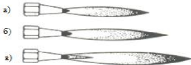
Слика 4.1 Облици ацетиленског пламена: а) оксидишући, б) неутралан и в) редукујући
