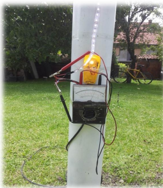
Слика 44: Тестирање рада траке са LED диодама
