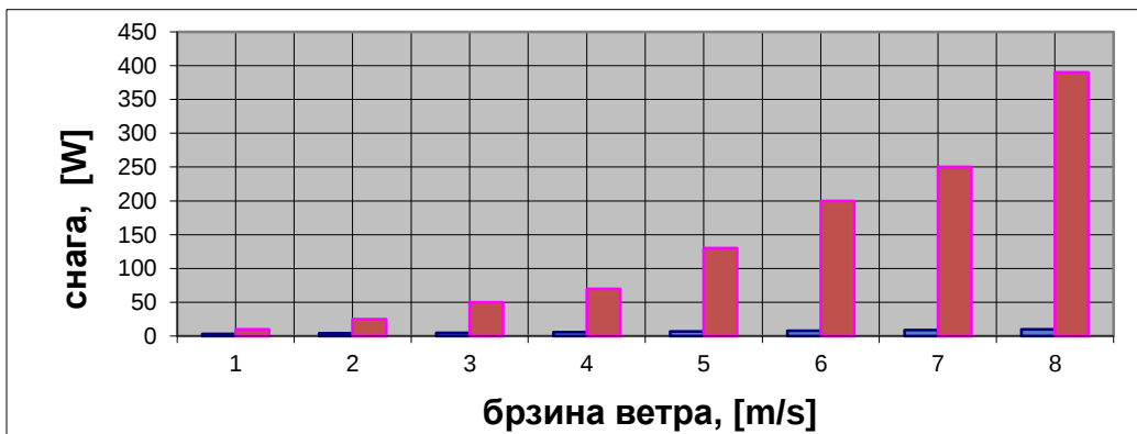
Слика 46: Снага коју генератор производи при различитим вредностима брзине ветра уколико је пречник елиса 2m [17]
