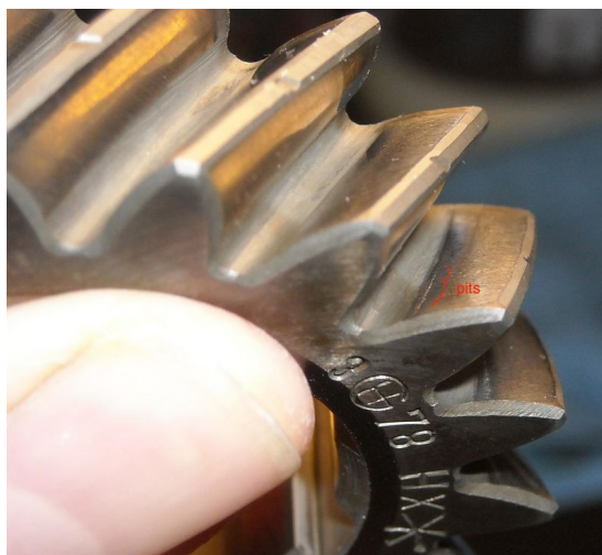
Слика 13. Пластична деформација у облику таласа ( Rippling )
