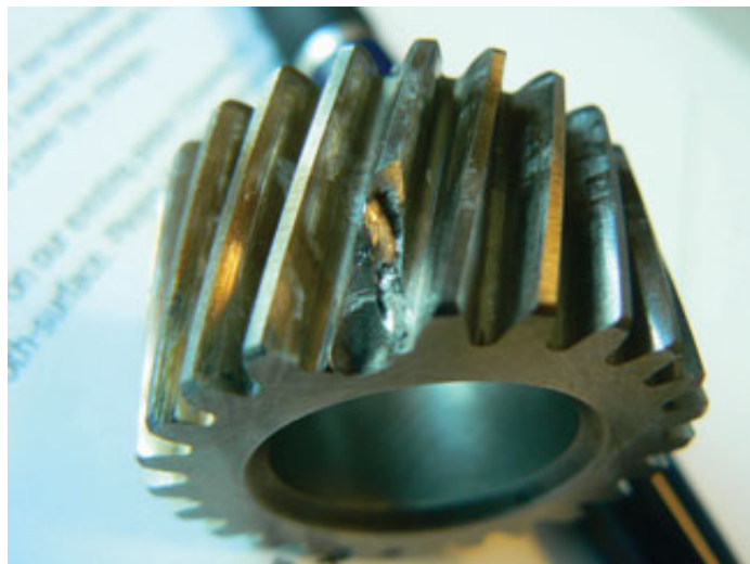
Слика 21. Зупчаник са поломљеним зупцима
