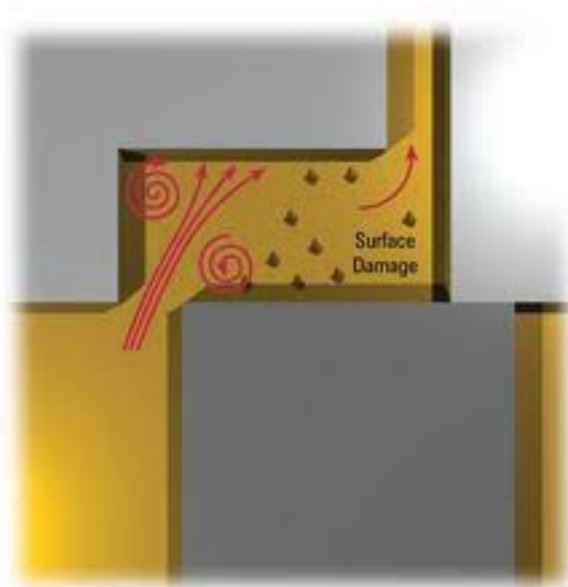
Слика 36. Ситуација у којој долази до кавитације
