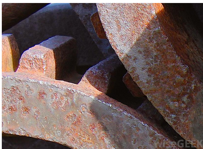
Слика 38. Изглед зупчаника којег је захватила оксидација
