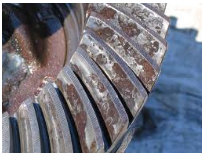
Слика 37. Уколико се корозија неоткрије брзо може довести до корозивног питинга
