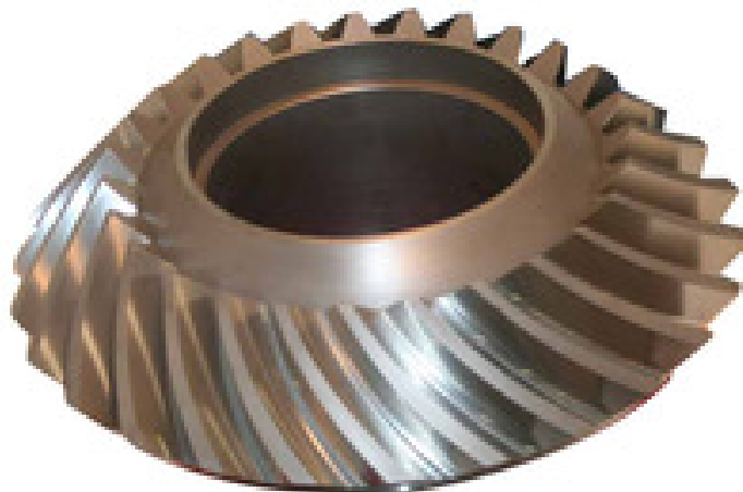
Слика 33. Спирални конусни зупчаник са фином абразијом
