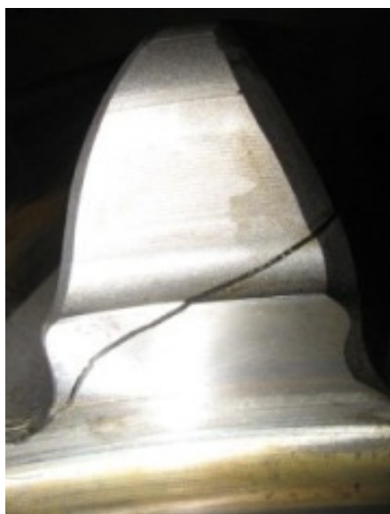
Слика 22. Пример типичног ломљења зупца
