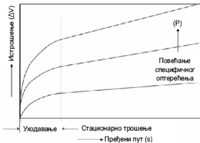
Слика 29. Дијаграм нормалног адхезивног хабања
