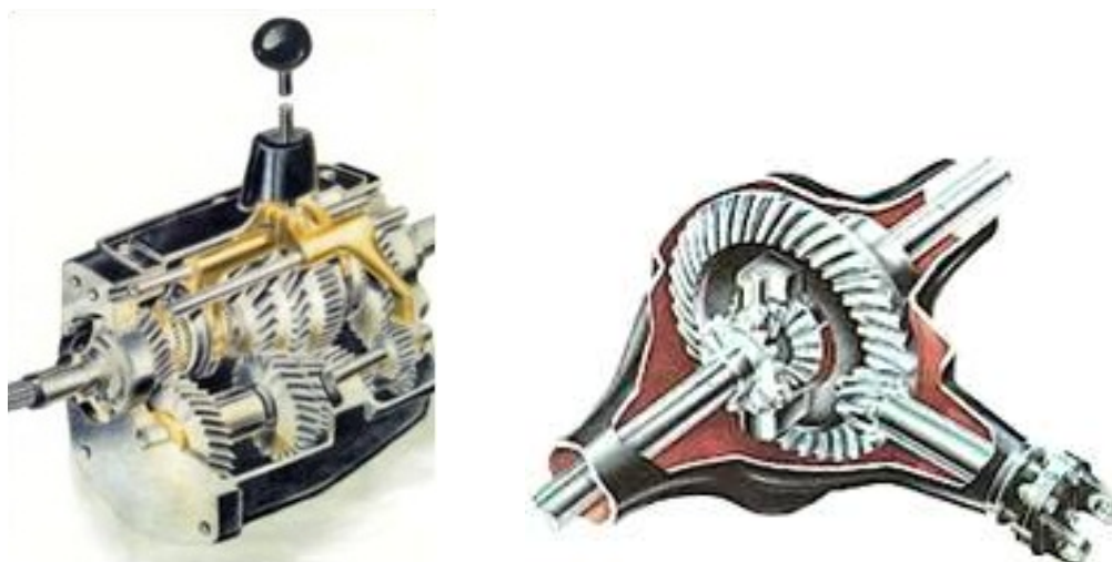
Слика 9. Изглед мењача и диференцијала
