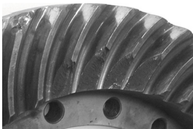
Слика 14. Пластична деформација зупчаника
