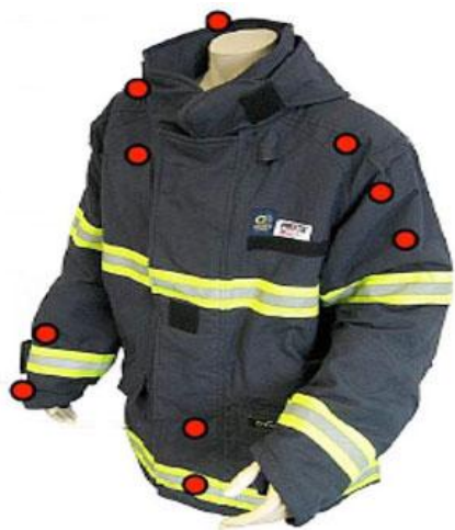
Слика 36. Заштитна радна јакна која у себи интегрише уређаје који детектују сигнале из окружења [32]
