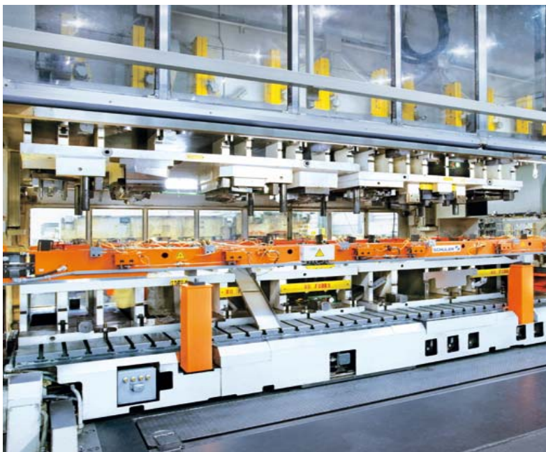
Слика 30 Модуларни електронски преносни системи са три осе
