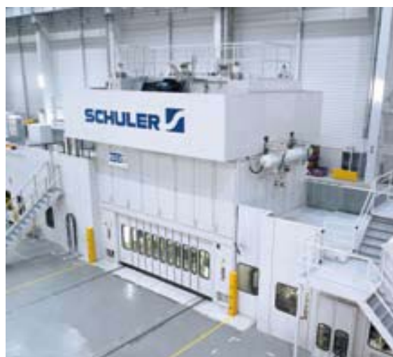
Слика 45 Преса са Servodirect технологијом
