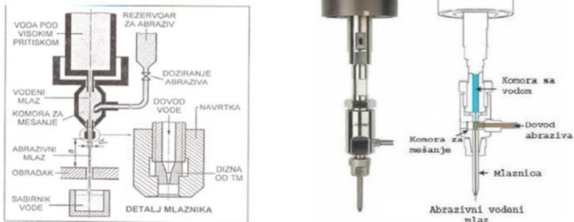
Слика 3. Изглед АЈМ апарата и његови делови [3]
