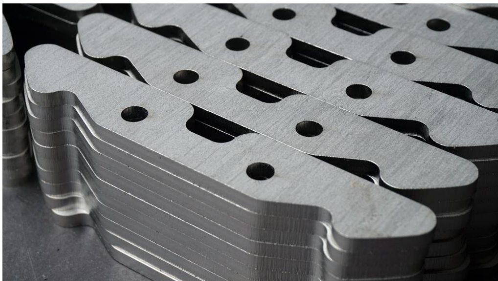
Слика 26. Резна ивица након сечења материјала
