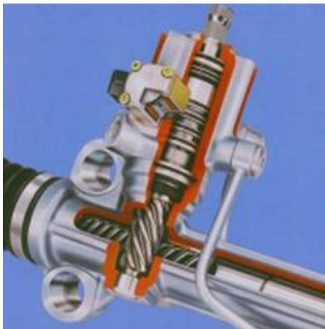
Слика 17. Управљачки механизам са зупчастом летвом
