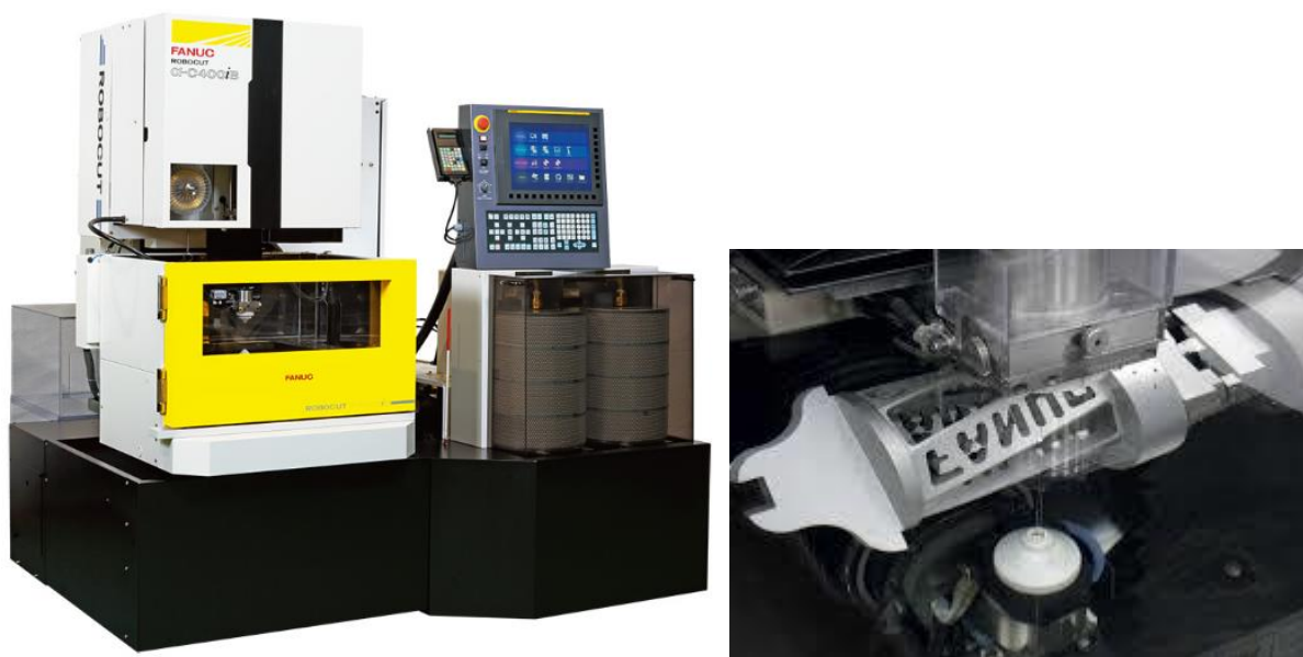
Слика 4.8: Fanuc Robocut C400iB и приказ горње и доње хлаве са обратком
