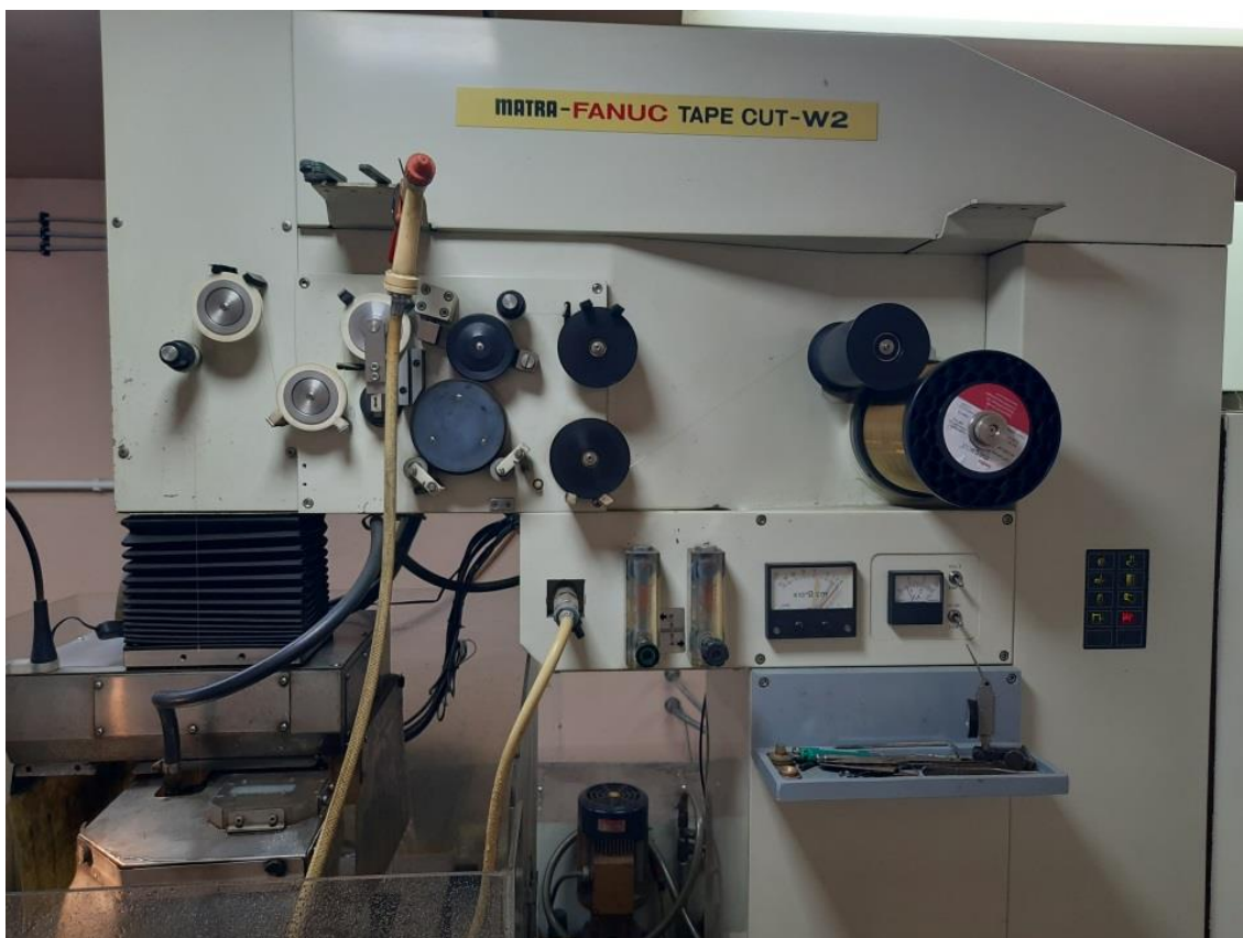
Слика 3.6: Калем и систем ваљака за довод и затезање жице
