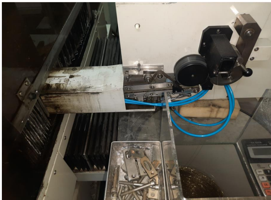
Слика 3.13 : Доњи каиш и систем котурова који избацују искоришћену жицу у spremник искоришћене жица
