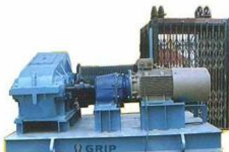
Слика 8. Примена витла за подизање лифта
