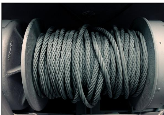
Слика 22. Неправилно намотано уже на добош витла
