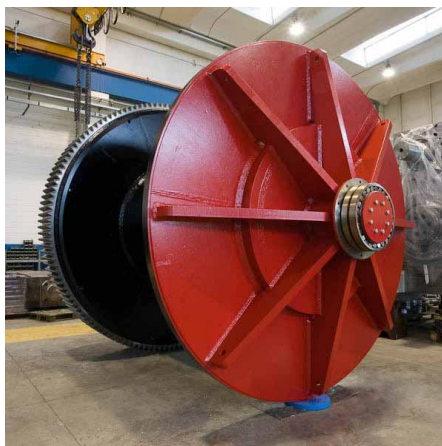
Слика 21. Укрућење бочних страна
