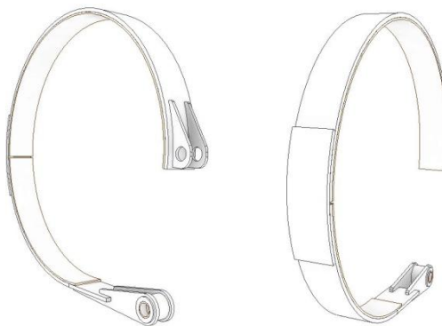
Слика 65. Обруч појасне кочнице
