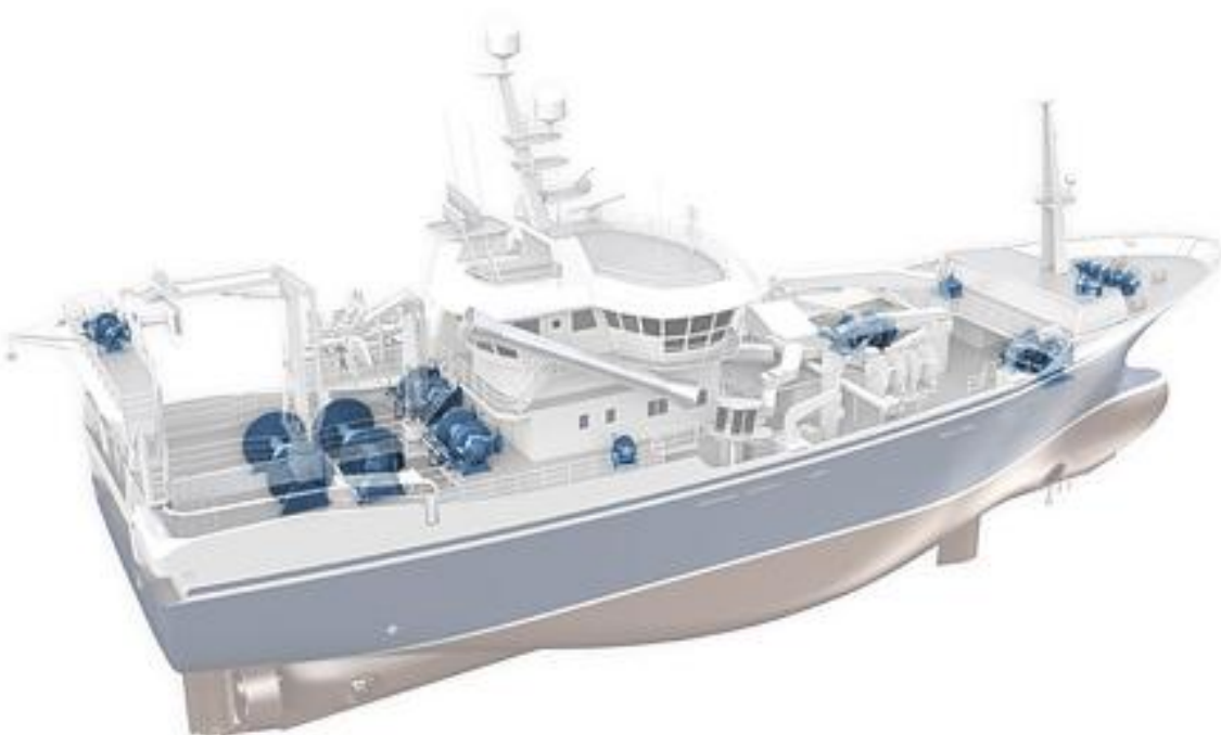
Слика 35. Приказ система витала на броду за рибарење повлачним мрежама
