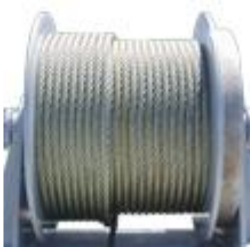
Слика 14. Добош витла са намотаним калемом ужета на себи
