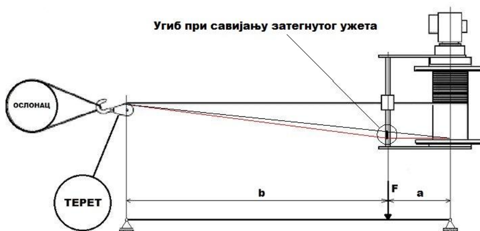
Слика 96. Положај ужета у коме је оптерећење највеће
