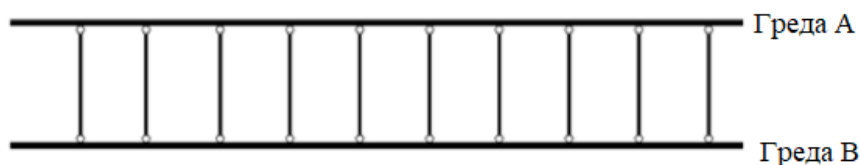
Слика 24. Панел подељен на две виртуелне греде [7]
