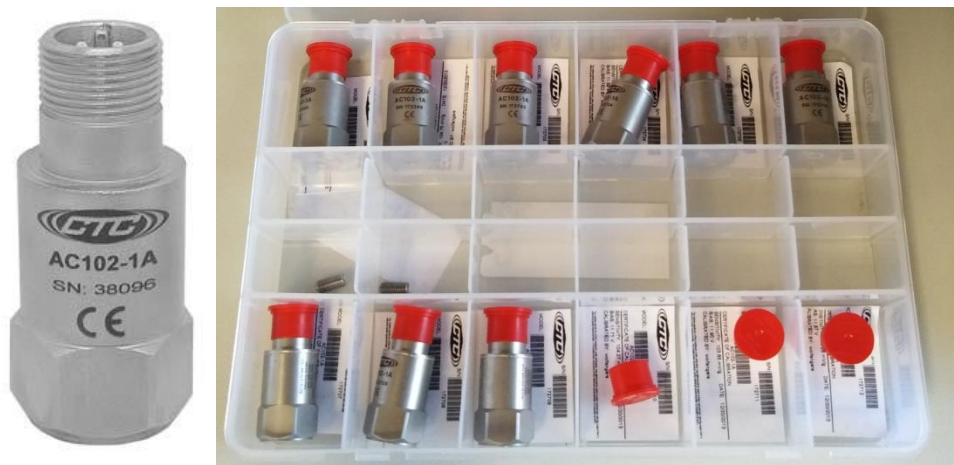
Слика 27. Давачи убрзања AC102-1A
