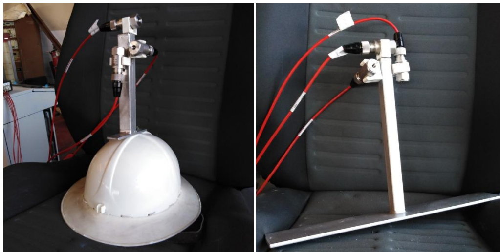
Слика 26. Давачи убрзања монтирани на кацигу (лево) и постоље (десно)
