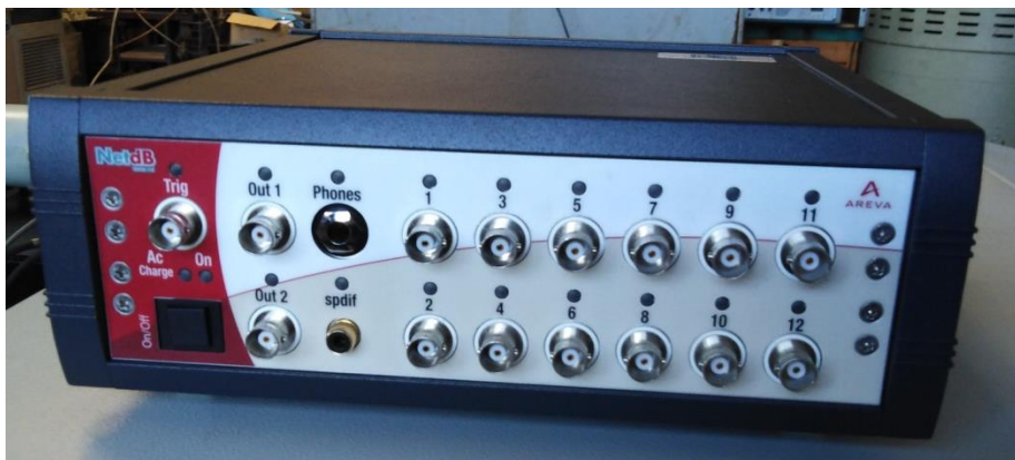
Слика 28. Дигитално мерно појачало NetdB PRO-132
