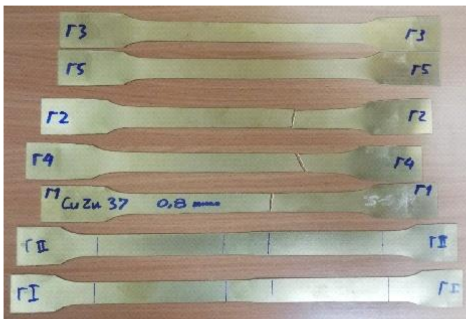
Слика 45. Епрувете од легуре CuZn37 пре и после експеримента
