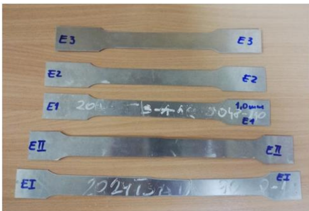
Слика 50. Епрувете од легуре AlCu4Mg1M пре и после експеримента
