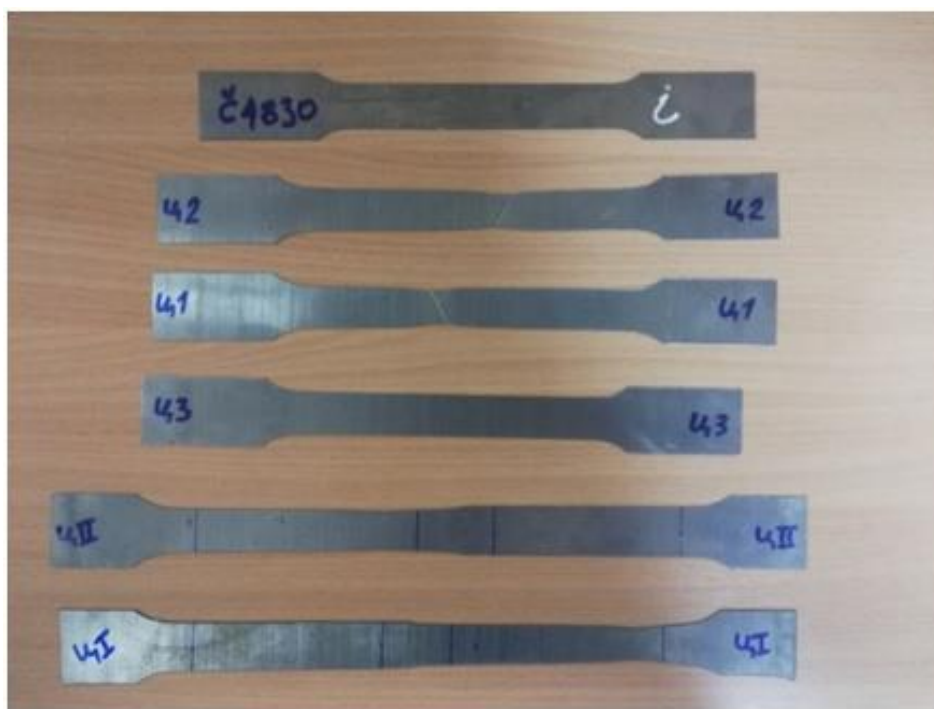
Слика 48. Епрувете од челика 51CrV4 пре и после експеримента
