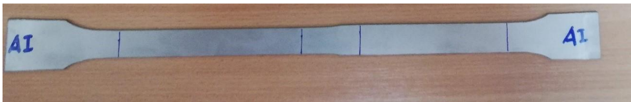
Слика 23. Изглед степенасте епрувете после затезања
