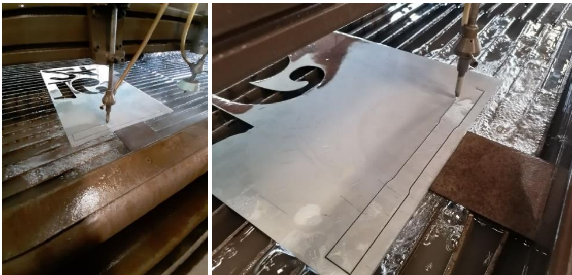
Слика 24. Израда епрувета абразивним воденим млазом ("Waterjet")
