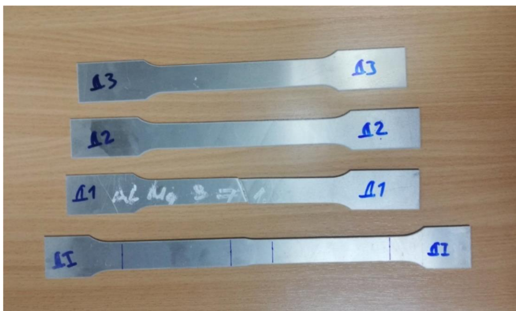
Слика 49. Епрувете од легуре AlMg3 пре и после експеримента
