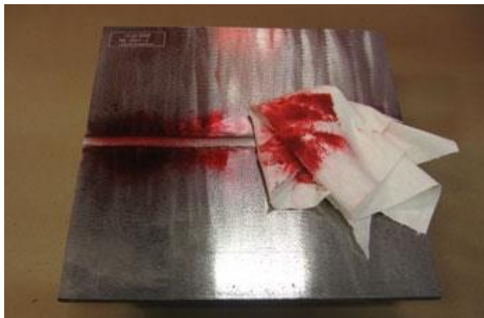
Слика 18. Одстрањивање вишка пенетранта с површине
