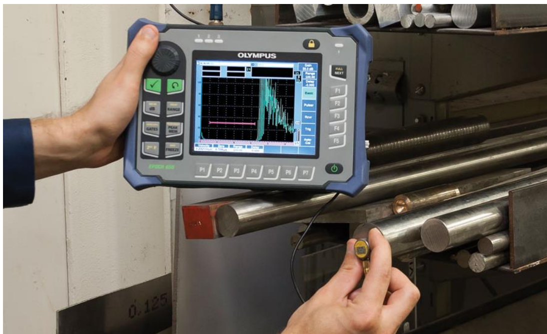
Слика 42. Аксијално испитивање металних шипки ултразвуком
