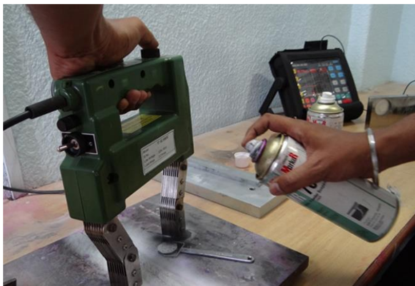
Слика 31. Одређивања грешака у магнетном пољу методом намагнетисавања електромагнетом
