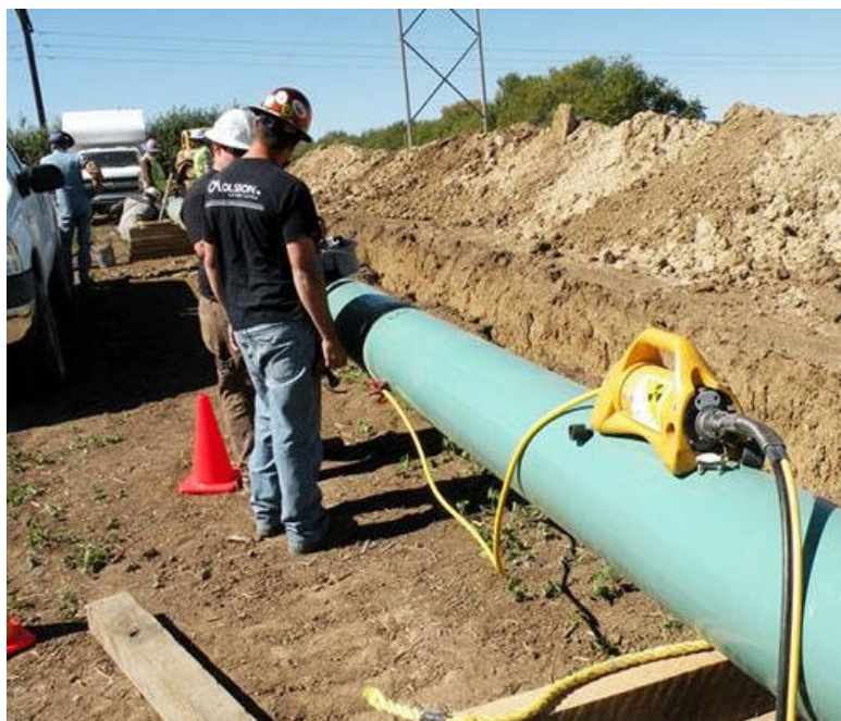
Слика 48. Извођење испитивања радиографском методом
