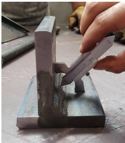
Слика 5. Визуелно-димензионаална контрола угаоног шава дебљине 10 mm
