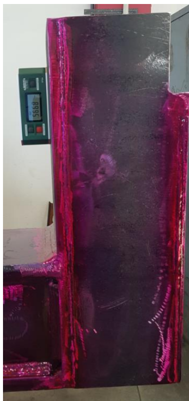
Слика 6. Провера управности завареног елемента конструкције
