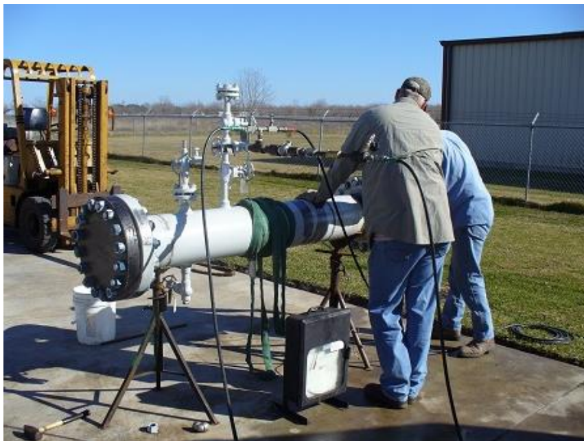
Слика 50. Тестирање воденим притиском
