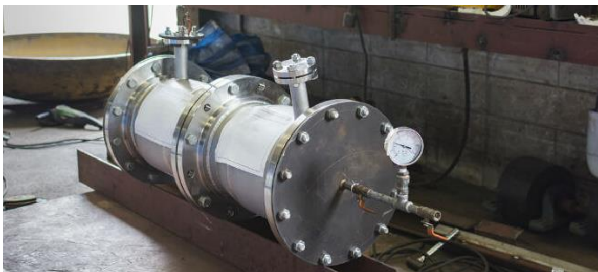
Слика 51. Припрема за тестирање гасним притисцима
