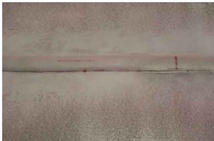
Слика 20. Појављивање пенетрантске индикације
