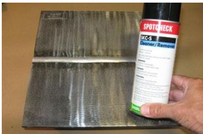
Слика 16. Припрема / чишћење површине
