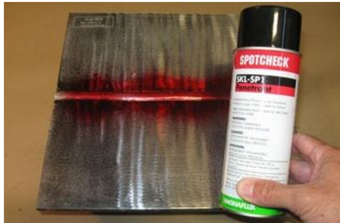
Слика 17. Наношење пенетранта
