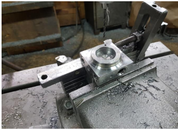
Слика 24. Бушење рупе Ø3
