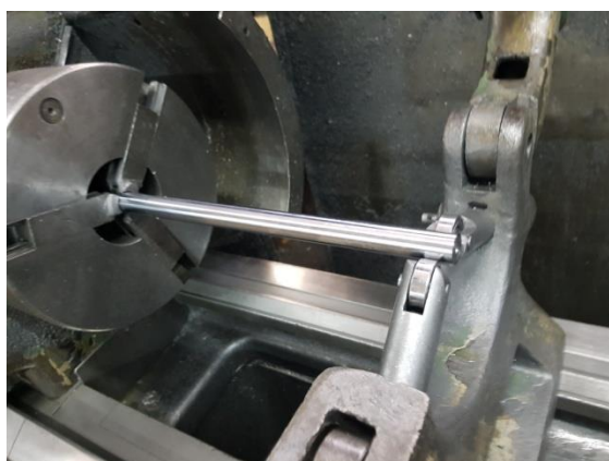
Слика 11. Поравнавање клипњаче
