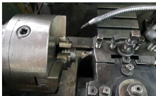
Слика 19. Вођица на стругу где се врши укопавање преосталих канала
