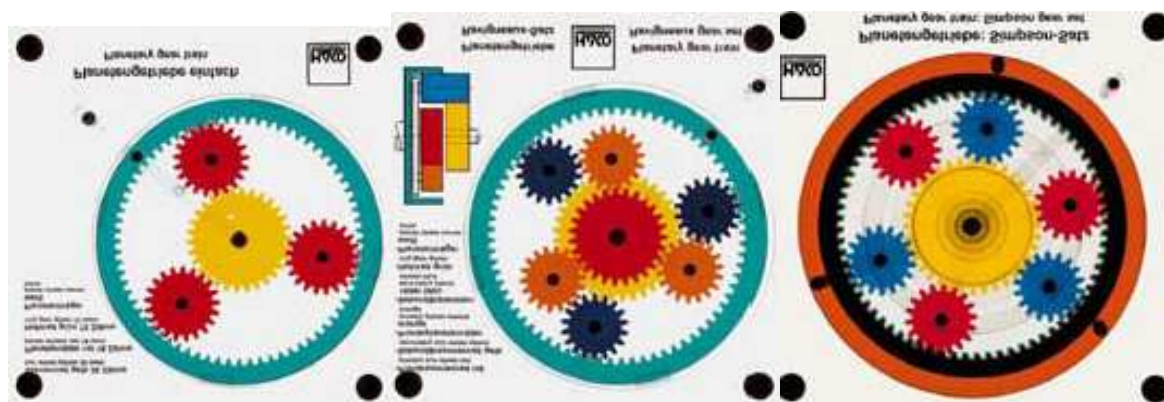
Слика 3.3 – Једноструки и двоструки планетарни преносник
