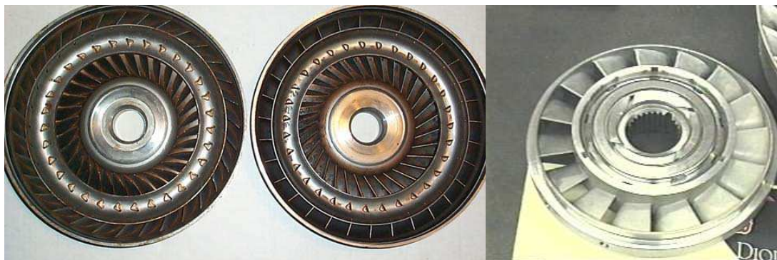
Слика 1.6 – Приказ лопатичних кола у турбомењачу
