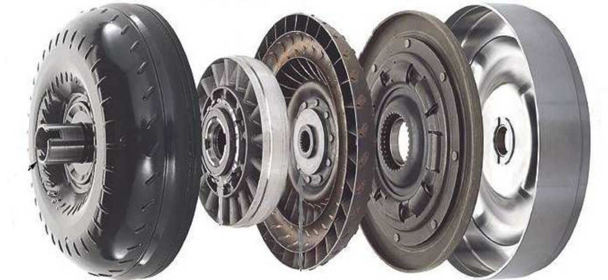
Слика 1.5 - Хидраулички део турбомењача
