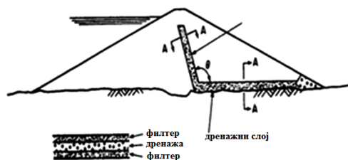
Слика 3.6. Насута брана хомогеног пресека с дренажом
