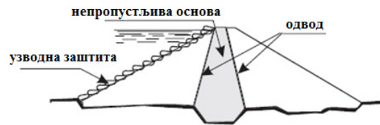
Слика 3.7. Брана са непропусним језгром
