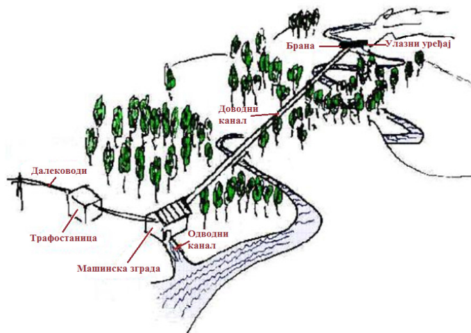
Слика 3.1. Шематски приказ једног хидропостројења
