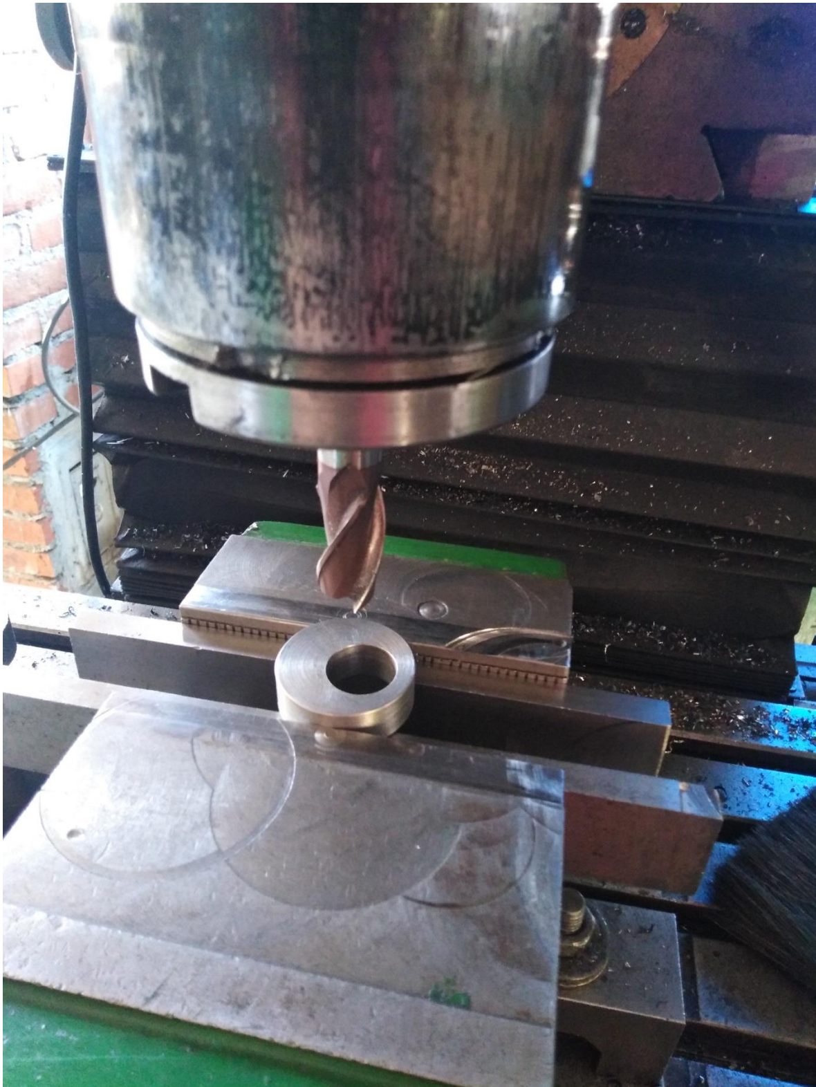
Слика 4.11 Израда отвора у ексцентар чаури
