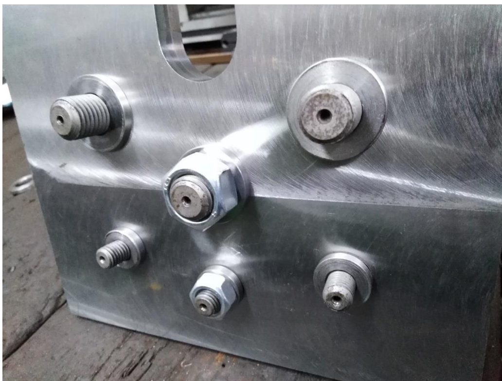
Слика 5.4 Осигуравање ваљака навојним спојевима
