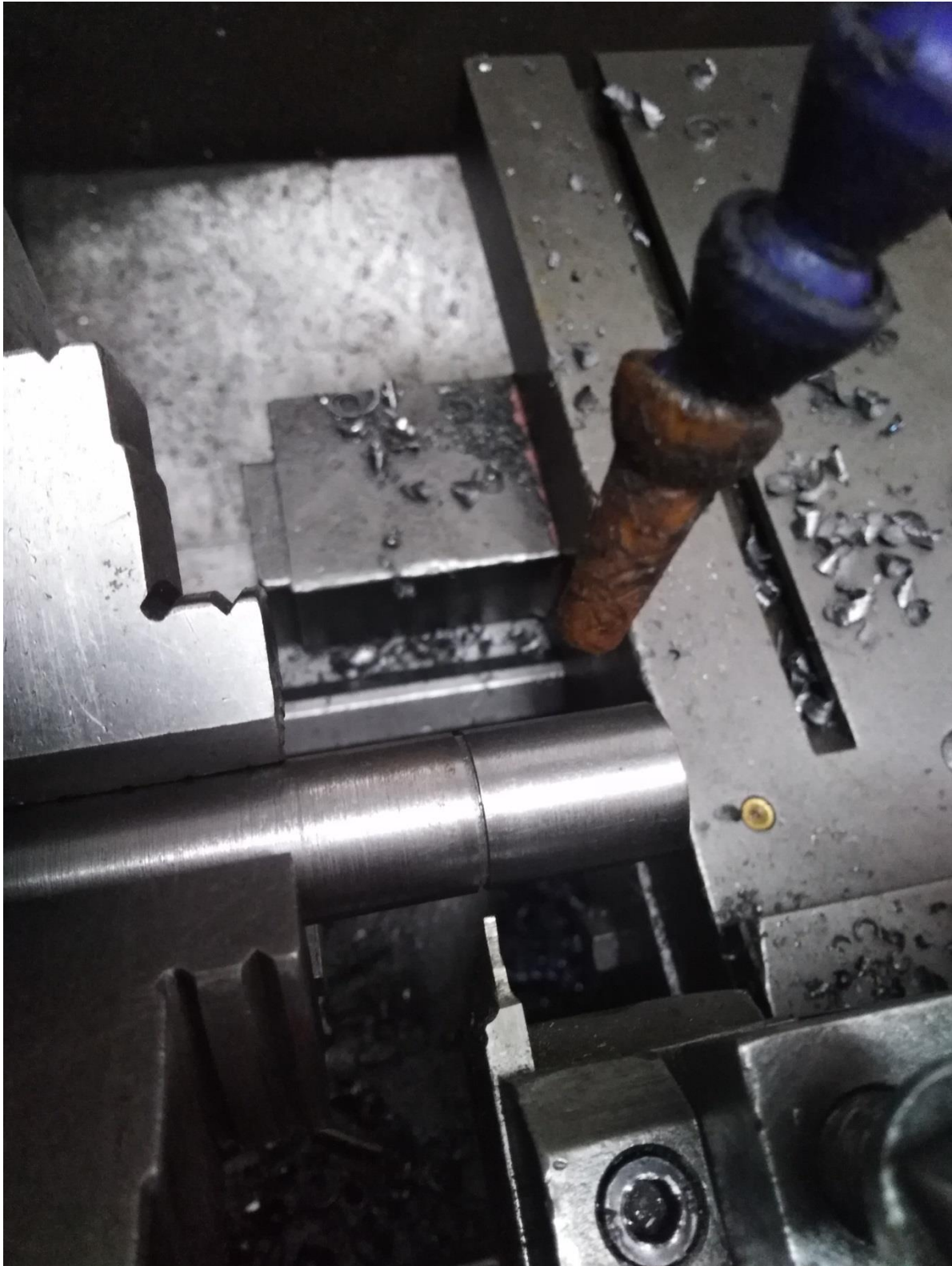
Слика 4.14 Израда канала за осигурач
