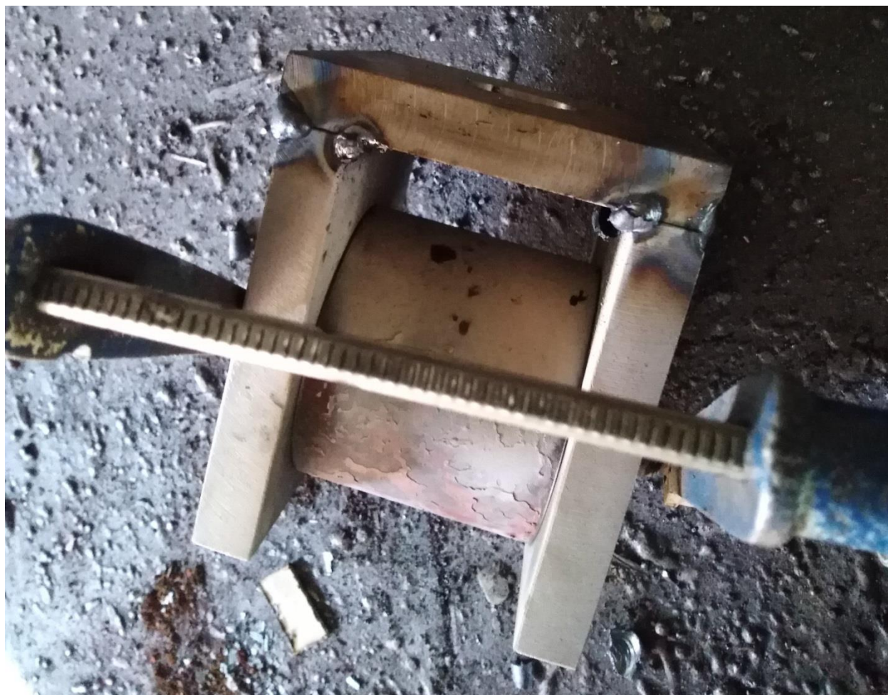
Слика 4.19 Заваривање плоча притискивача
