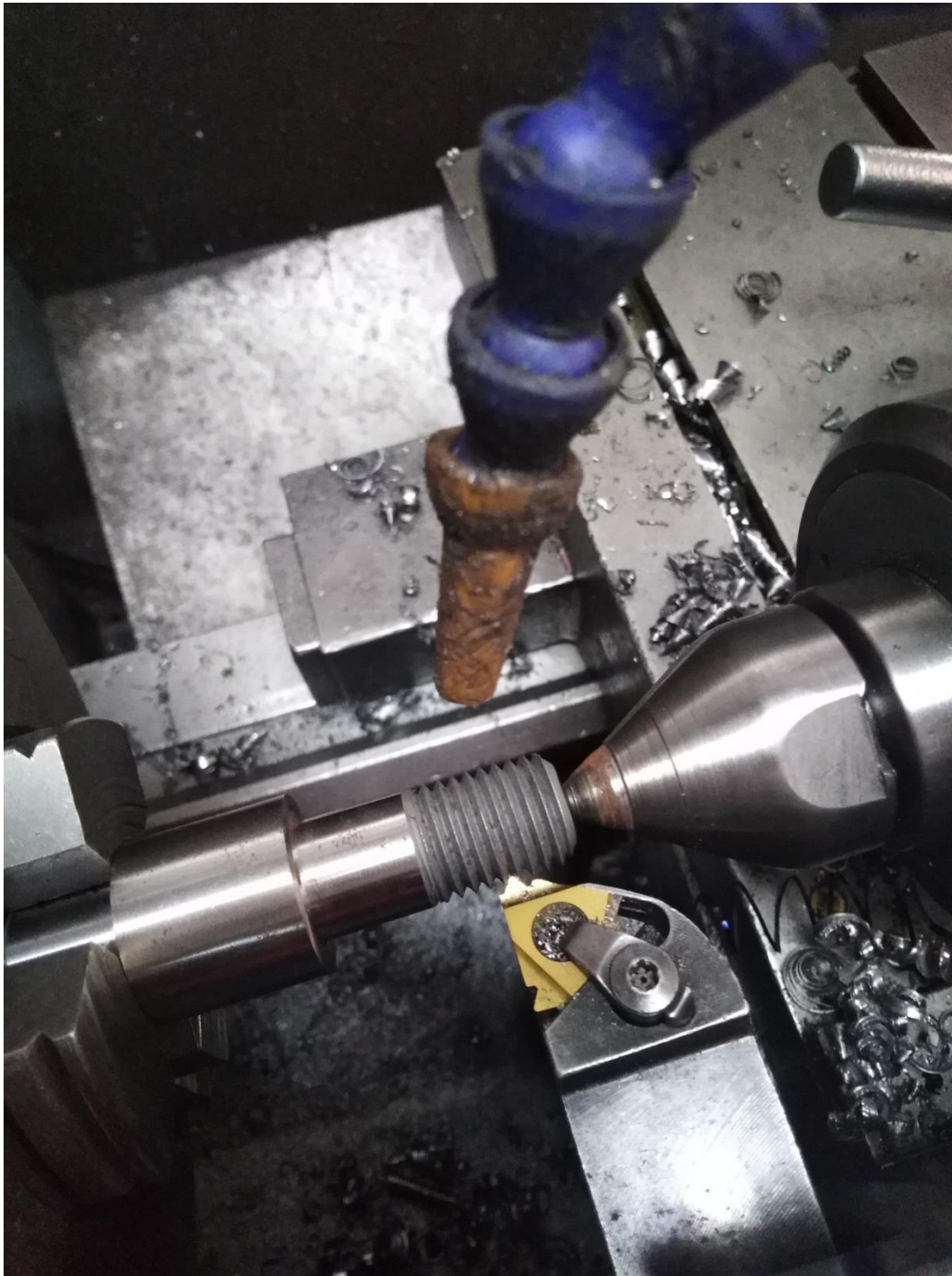
Слика 4.7 Израда навоја М16 (излазни ваљак)
