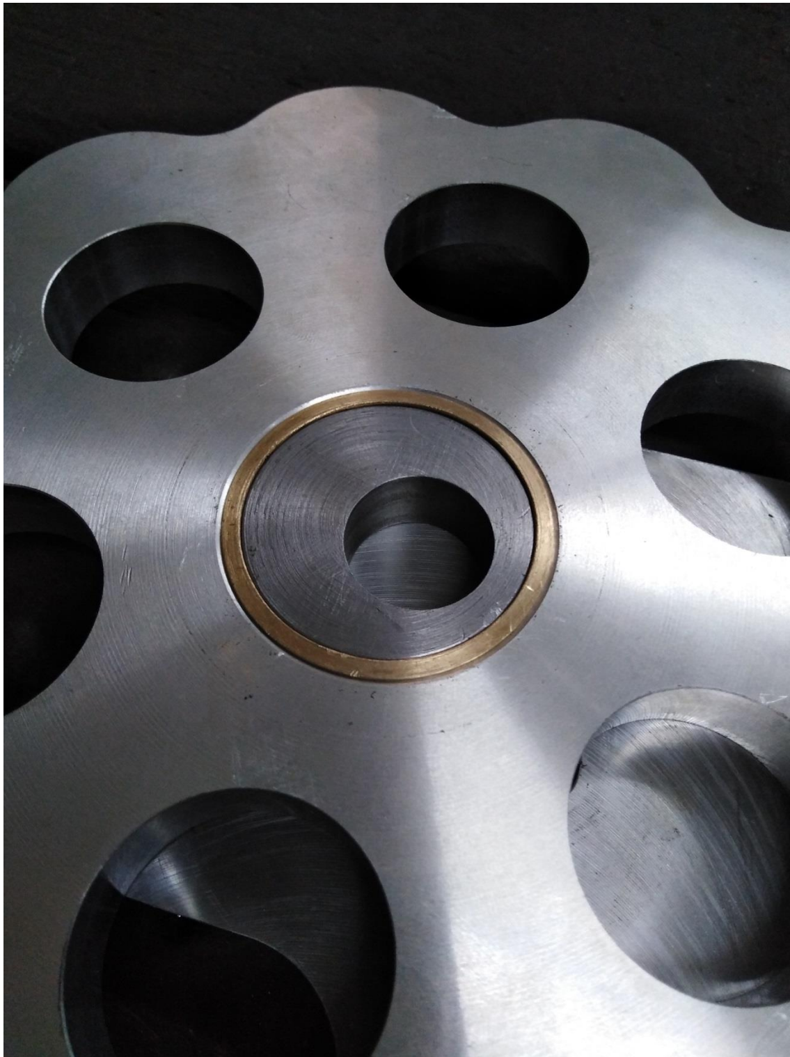
Слика 5.2 Монтирање чауре у отвор циклозупчаника
