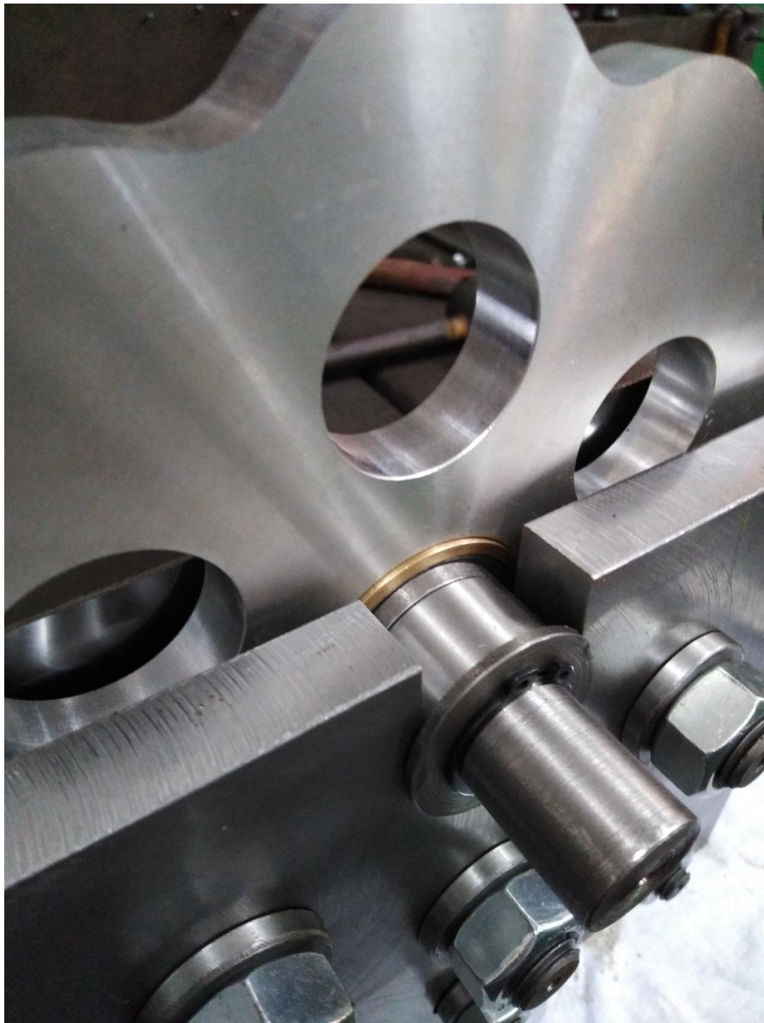
Слика 5.6 Монтажа вратила
