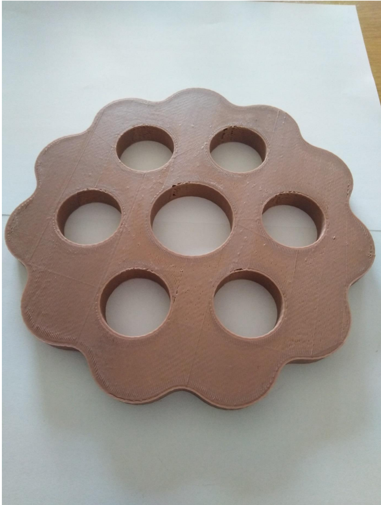
Слика 4.3 Циклозупчаник добијен поступком 3D штампе
