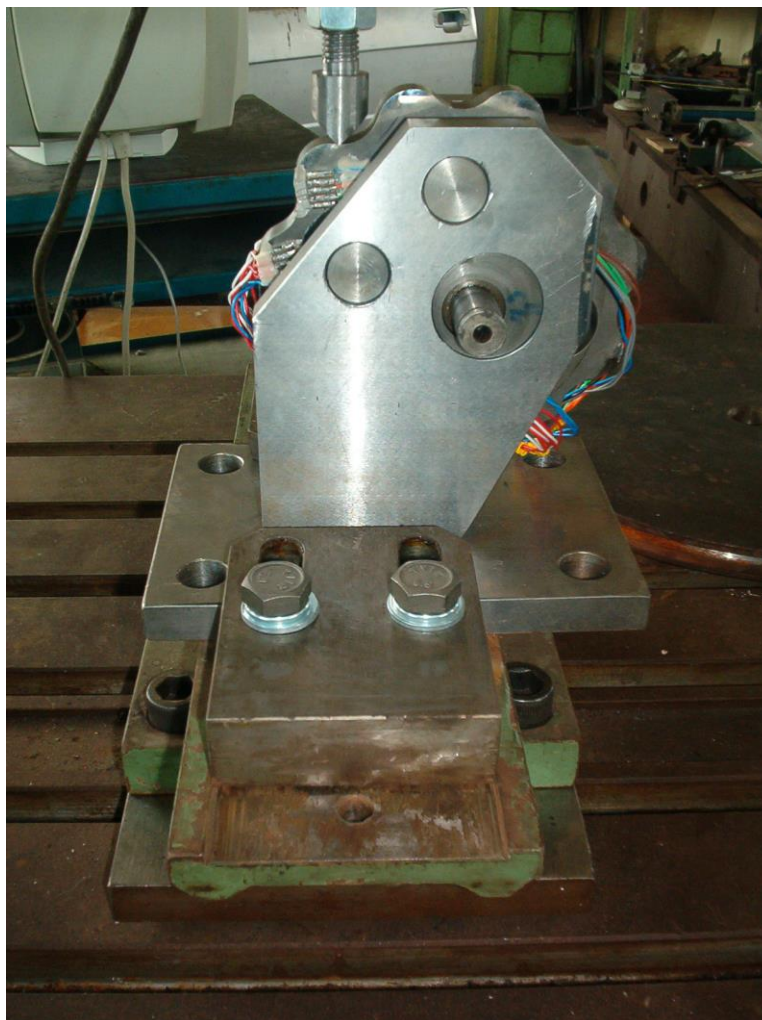
Слика 3.1 Алат за одређивање напонско-деформационог стања циклозупчаника, [4]
