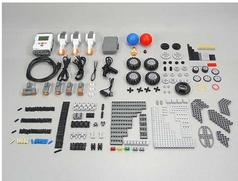
Слика 15. LEGO коцке од којих се састављају роботи из сета NXT. [13]
