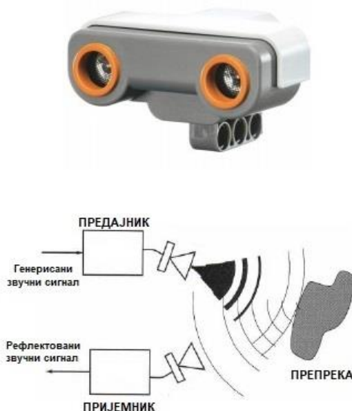
Слика 10. Изглед ултразвучног LEGO сензора и скициран принцип рада. [6]
