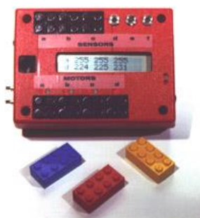
Слика 2. Прва паметна коцка развијена у сарадњи MIT и LEGO компаније. [4]
