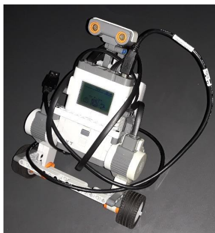
Слика 23. LEGO NXT самобалансирајући робот.
