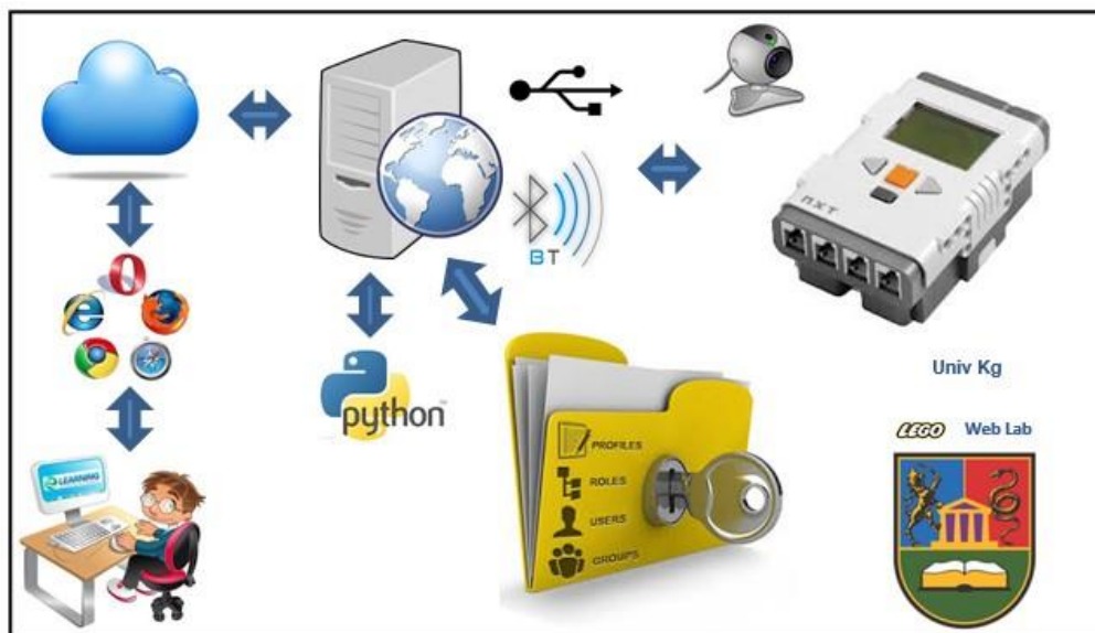
Слика 19. Концепт рада LEGO Web лабораторије на Факултету инжењерских наука. [2]
