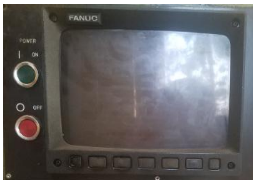
Слика 4.2 Дисплеј помоћу кога се посматра код који се уноси ручно и одређени параметри машине
