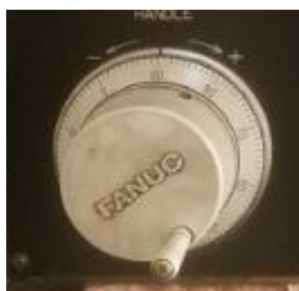
Слика 4.4 Обртни потенциометар помоћу кога се позиционира носач алата и алат (ручно помера)
