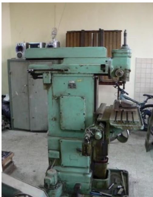
Слика 2.2.1 Конвенционална глодалице серије SF [7]
