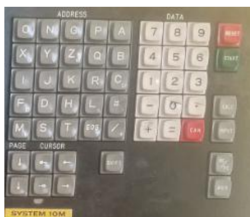
Слика 4.3 Тастатура на управљачкој јединици помоћу које се позиционира алат и ручно уноси код
