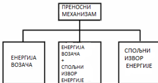
Слика 5. Преносни механизми[4]
