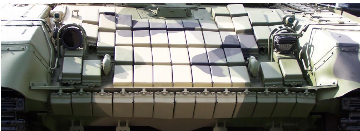
Слика 10. Експлозивно реактивни оклоп „Контакт-5“ на чеоној оклопној плочи тенка Т-72 [1]
