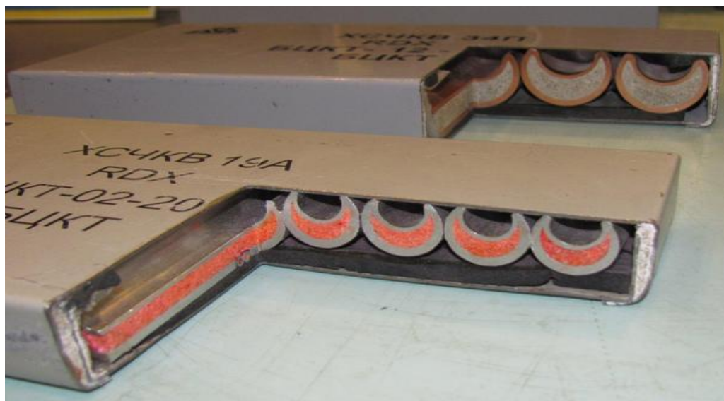
Слика 12. Изглед пресека касете експлозивног реактивног оклопа „Нож“ [5]
