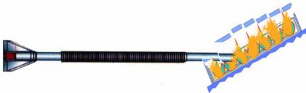
Слика 13. Принцип рада експлозивног реактивног оклопа „Нож“ [5]
