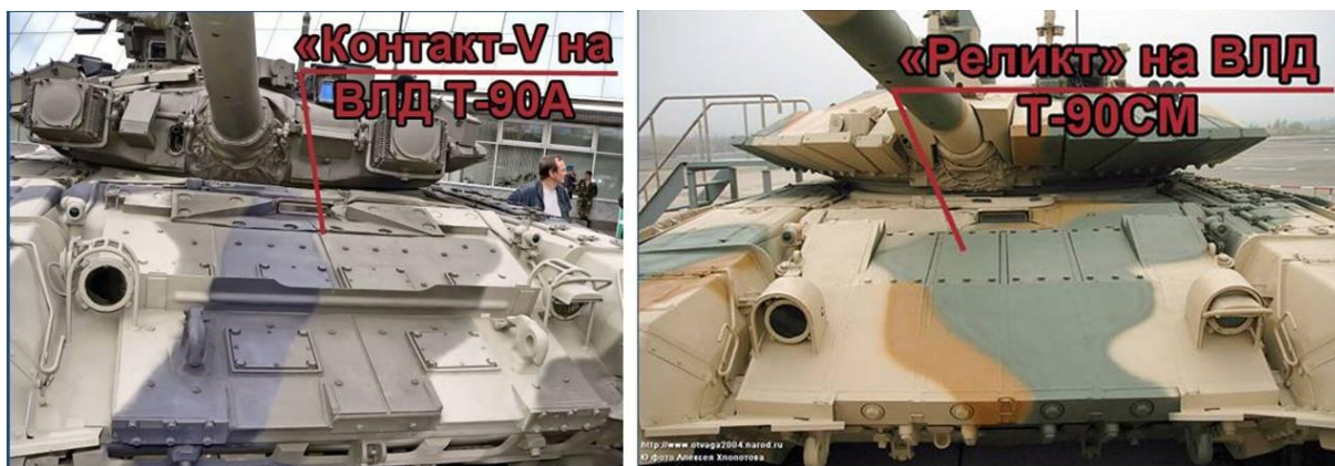
Слика 11. Упоредни приказ експлозивног реактивног оклопа „Контакт -5“ на тенку Т-90А и експлозивног реактивног оклопа „Реликт“ на тенку Т-90СМ [5]
