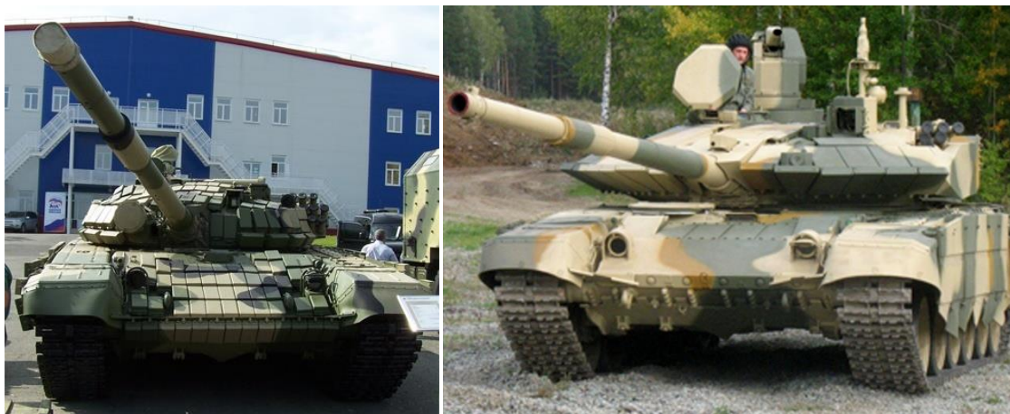
Слика 6. Експлозивни реактивни оклопи на модернизованом тенку Т-75 (лево) и Т-90 (десно) [5]
