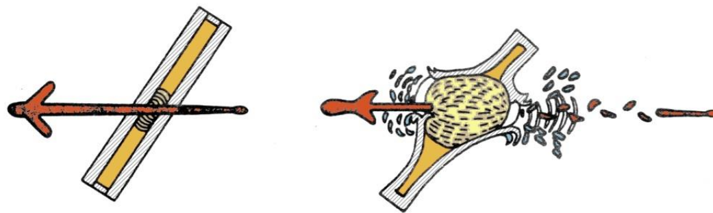
Слика 5. Шематски приказ дејства експлозивног реактивног оклопа [6]
