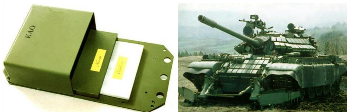
Слика 14. Изглед пресека касете КАО М99 (лево) и експлозивног реактивног оклопа М99 на модернизованом тенку Т55 (десно) [5]
