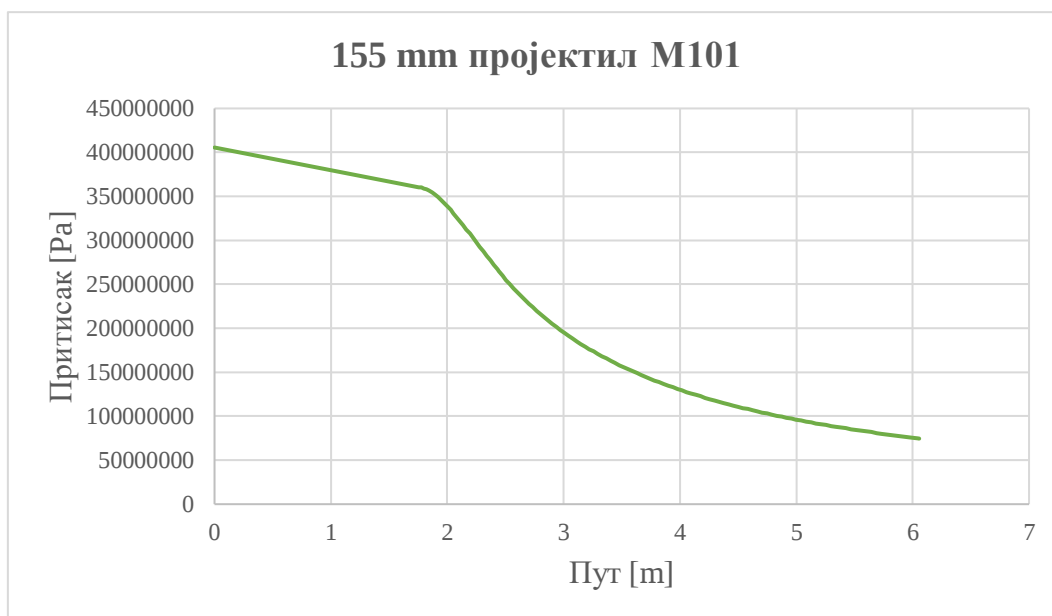
Дијаграм 3.2.1 Промена притиска барутних гасова у зависности од пута за конвертовану цев
