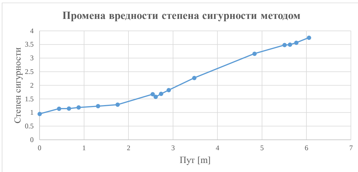
Дијаграм 3.2.6 Промена вредности степена сигурности одређена методом Huber - Mises - Henki за конвретовану цев
