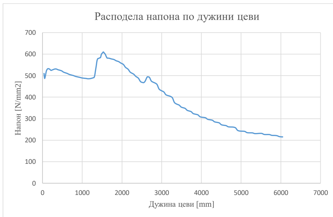
Дијаграм 4.1 Расподела напона по дужини цеви
