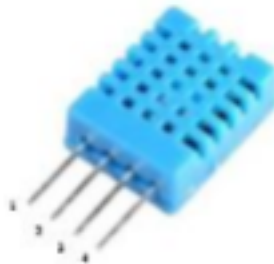
Слика 2. Приказ DHT11 сензора са означеним пиновима
