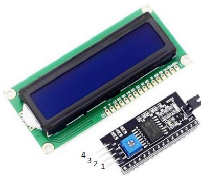
Слика 2.4. LCD модул са означеним пиновима
