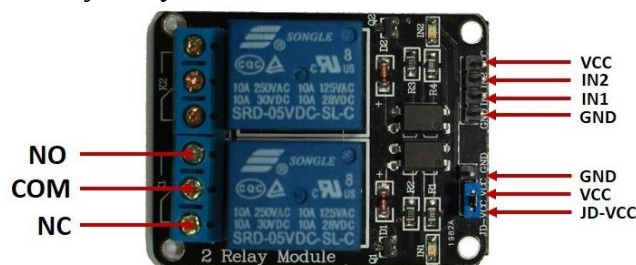
Слика 2.6. Relay модул са означеним пиновима
