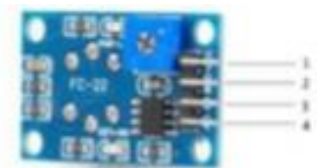
Слика 2.1. Приказ fc-22 сензора са означеним пиновима
