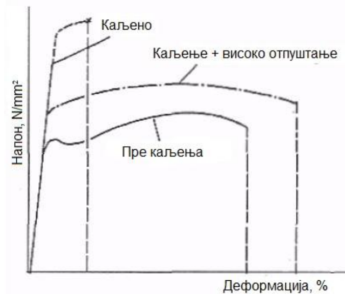
Слика 4.10 Дијаграм напон-деформација (издужење) пре каљења, после каљења и после побољшања [3]
