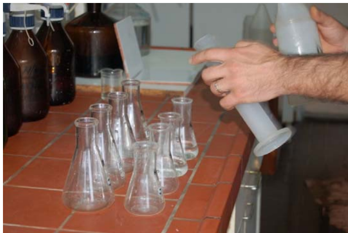
Слика 36.- Сипање узорка воде у епрувете (сирова вода, коагулатор 1, коагулатор 2, вода за пиће)
