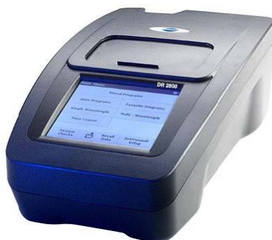
Слика 31.- Спектрофотометар фирме Hach-Lange (тип: DR 2800 Portable)
