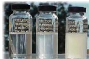
Слика 26.- Стандардни узорци различите мутноће воде (5, 50, и 500 NTU )
