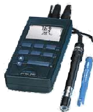
Слика 32.- Кондуктометар (Инструмент за одређивање проводљивости-фирма: WTW мултипараметарски)
