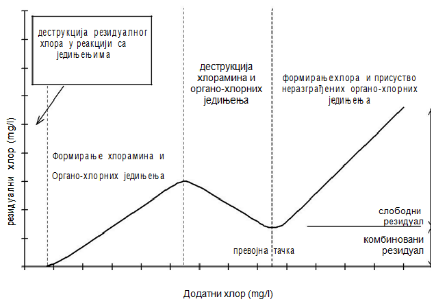
Слика 49.- Хлорисање у присуству амонијака до пробојне тачке
