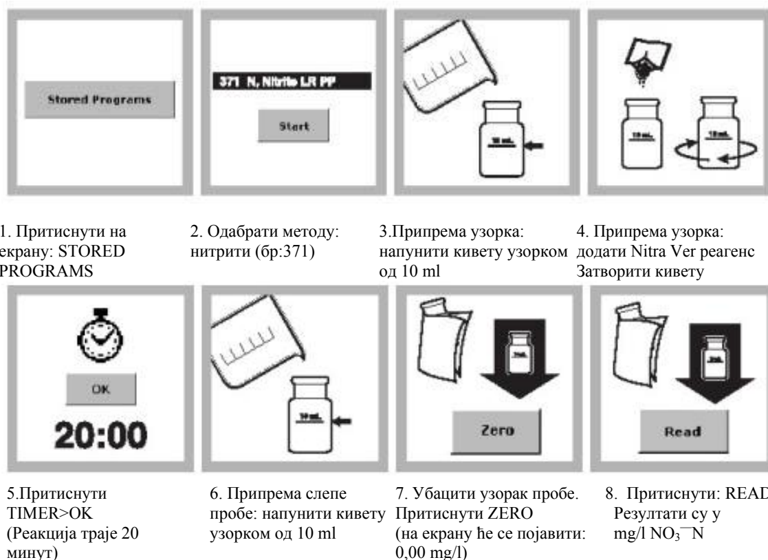
Слика 45.-Одређивања нитрита на “НАСН” спектрофотометру
