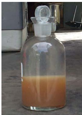
Слика 42.- Винклерава боца за одређивање кисеоника
