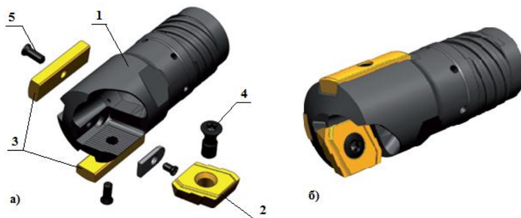
Слика 3.25. Алат за дубоко бушење са једним ножем (ејекторски принцип); а) делови главе за бушење; 1 – тело алата, 2 – резна плочица, 3 – вођице, 4 – вијак за причвршћивање резне плочице, 5 – вијак за причвршћивање вођице. б) глава за бушење [7]
