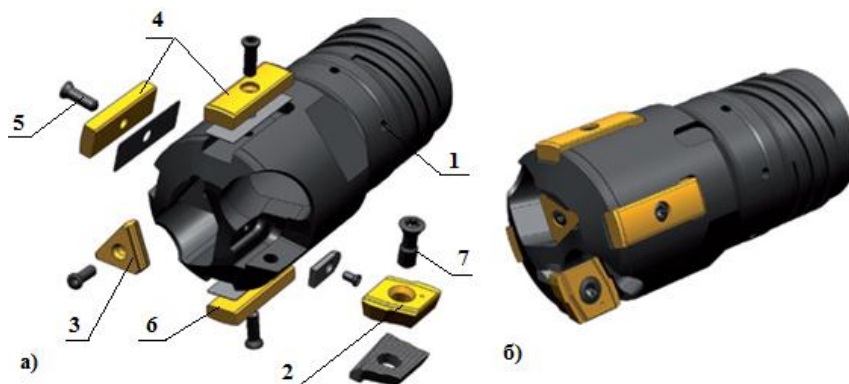
Слика 3.27. Алат за дубоко бушење са два ножа (ејекторски принцип); а) делови главе за бушење; 1 – тело алата, 2 и 3 – резне плочице, 4 и 6 – вођице, 7 – вијак за причвршћивање резне плочице, 5 – вијак за причвршћивање вођице. б) глава за бушење [7]
