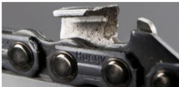
Слика 3.21 Абразивно похабан резни зуб
