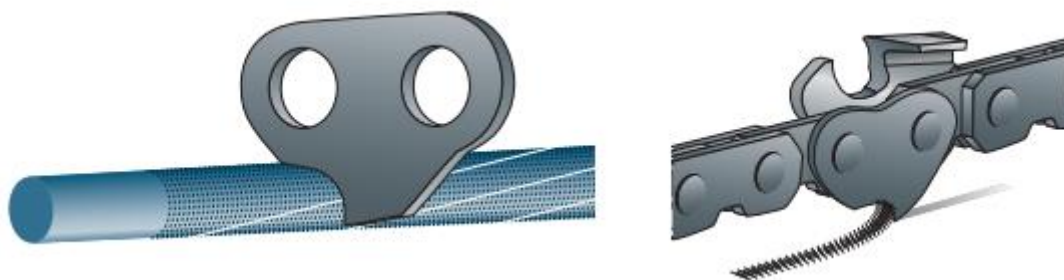
Слика 3.27 Поновно брушење погонске ламеле
