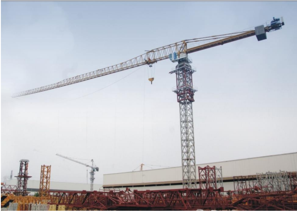
Слика 2.2 Грађевинска дизалица са хоризонталном непокретном стрелом [3]
