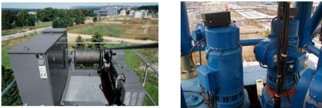
Слика 4.1 Погонски механизам грађевинских дизалица [7]
