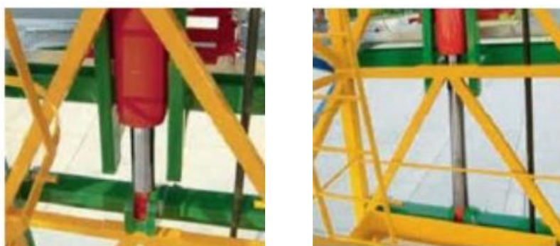
Слика 2.9 Хидраулични цилиндар за подизање [11]
