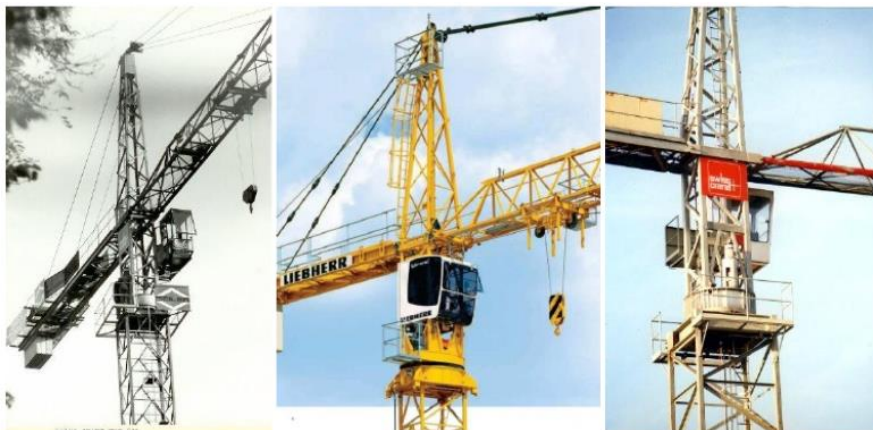
Слика 3.5 Командна кабина грађевинских дизалица [7]
