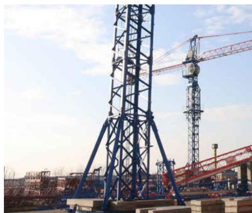
Слика 3.7 Доњи построј грађевинских дизалица [10]
