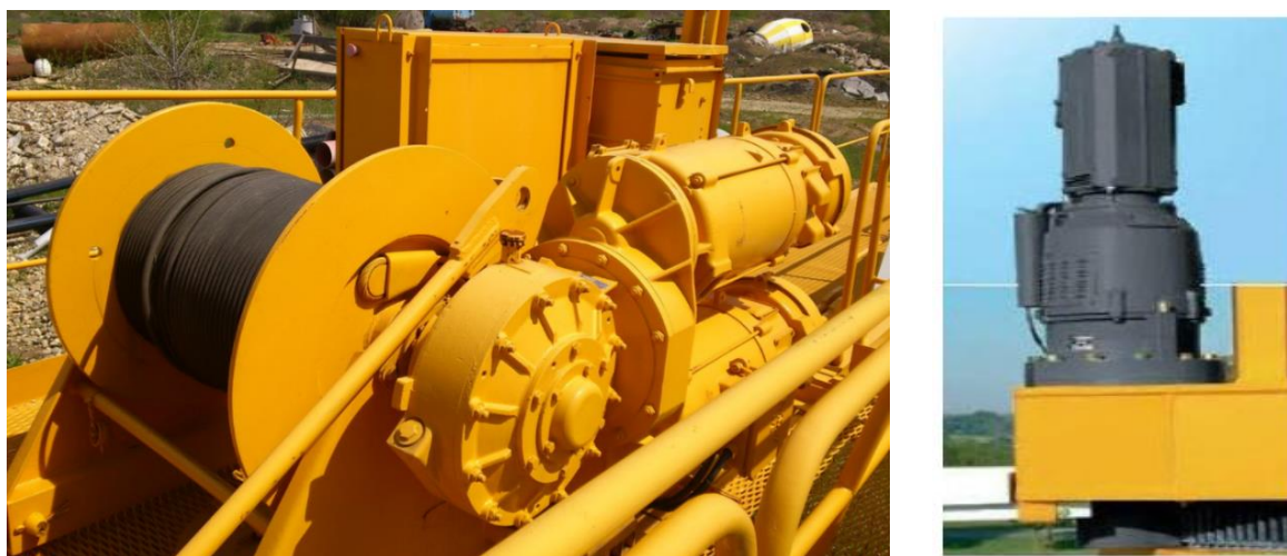
Слика 4.2 Погон кретања колица са вучним бубњем и погон обртања [3]
