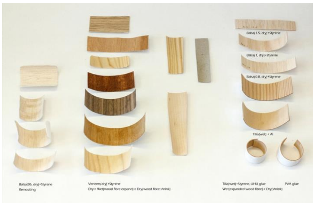
Слика 30. Слојеви материјала који су коришћени за производњу површина који делују на кишу [27]
