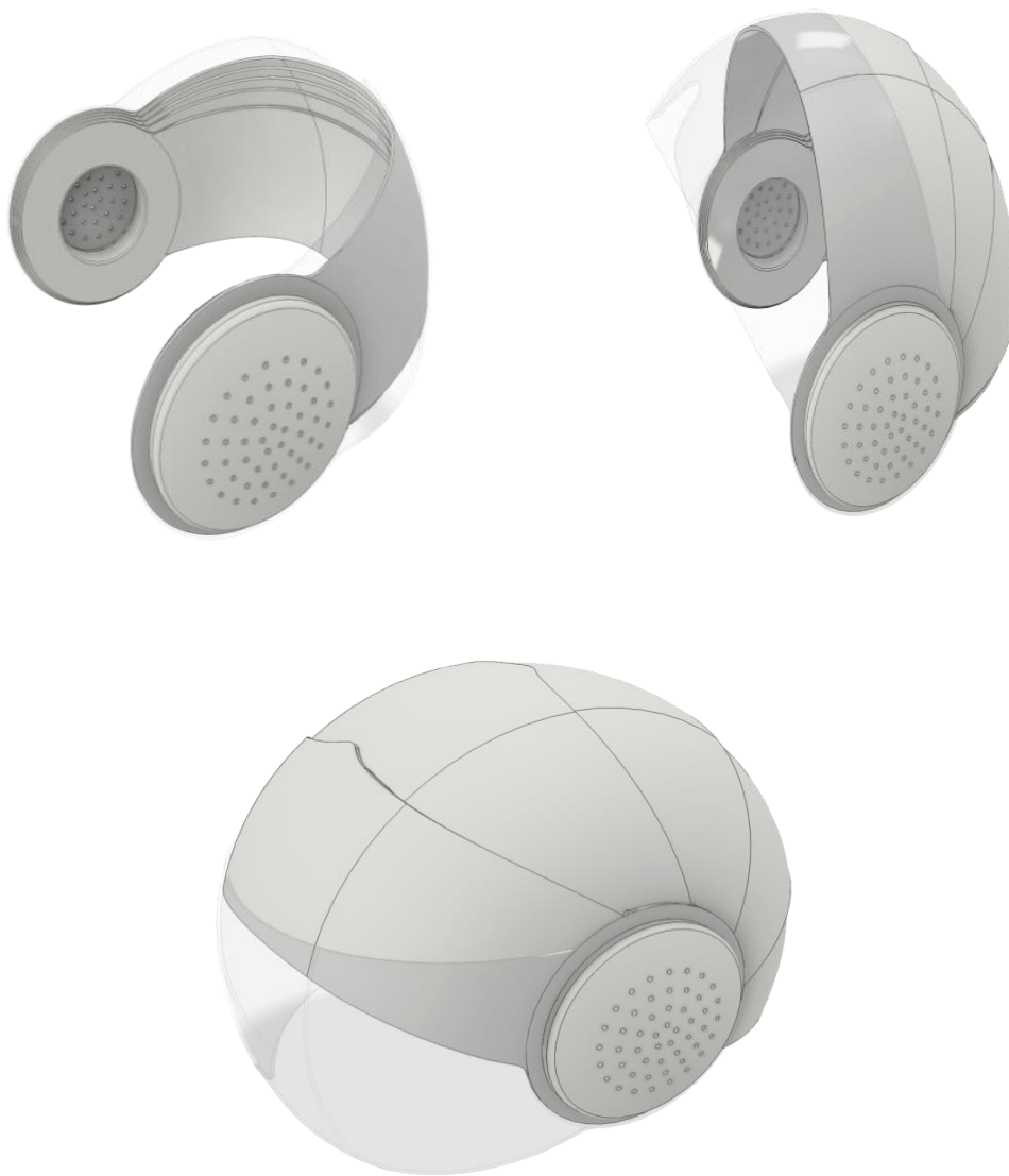
Слика 42. Фазе кациге од збијеног до развијеног облика
