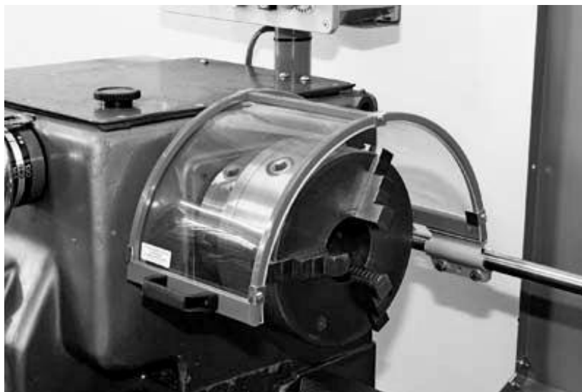
Слика 21. Заштита стезне главе код струга
