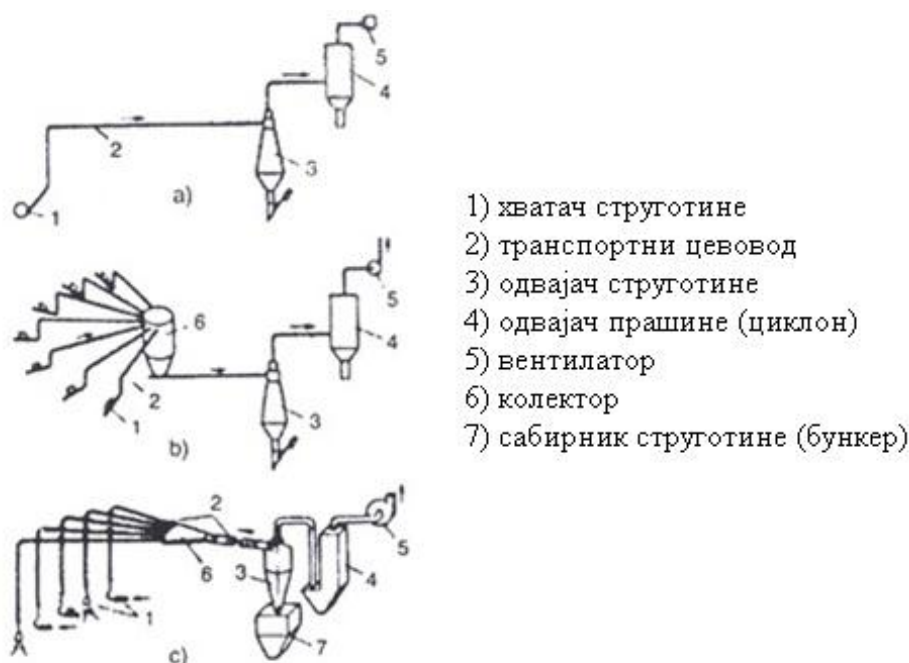
Слика 20. Шематски приказ различитих пнеуматских инсталација за уклањање струготине, а) индивидуална инсталација, б) и в) сложене инсталације
