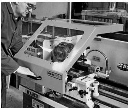
Слика 28. Положај штитника на стругу за време трајања обраде
