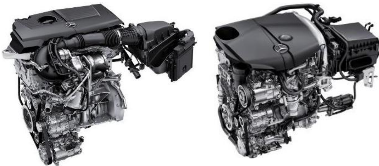
Слика 7.2 – Лево – бензински (ОТО) мотор Mercedes – Benz M 270 DE 16 AL; Десно – дизел мотор Mercedes – Benz OM 651 DE 18 LA [37]
