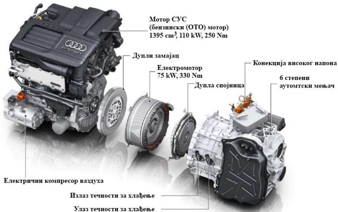
Слика 7.5 – Погонска јединица хибридног возила Audi A3 Sportback e – tron (PHEV) [41]
