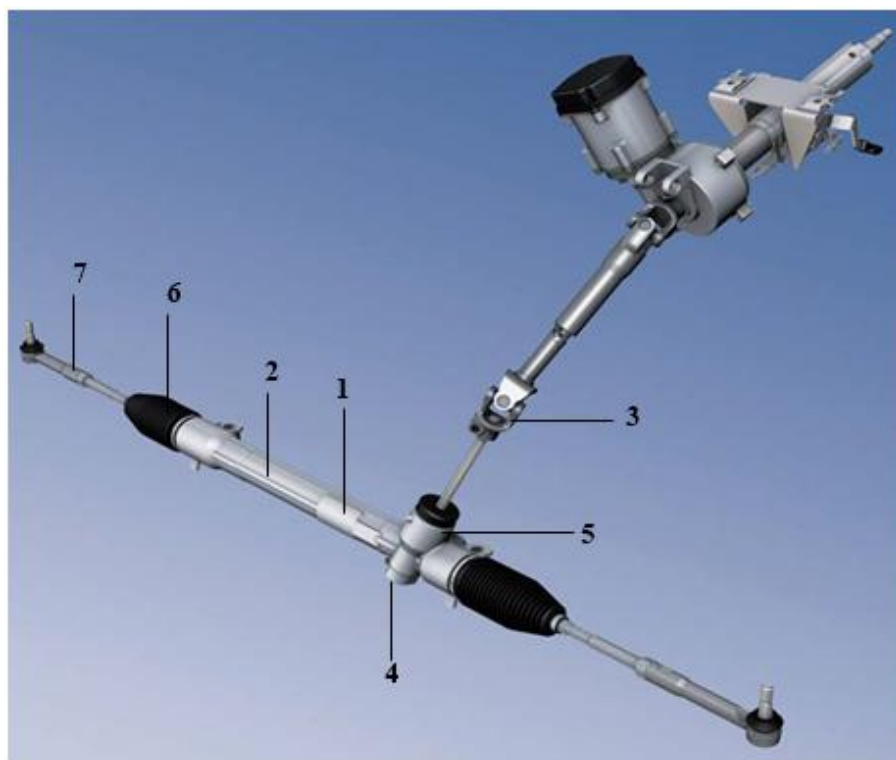
Слика 7.15 – ZF EPSc електрични серво управљач (1. кућиште, 2. зупчаста летва, 3. стуб управљача – карданско вратило, 4. преносни зипчаник, 5. управљачки преносник, 6. гумена заштита, 7. спона) [40]
