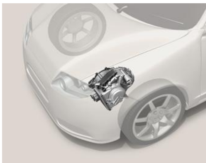
Слика 7.6 – Лево – позиција мењачког преносник ZF 9HP 48 на аутомобилу; Десно – мењачки преносници ZF 9HP 28 (горе) и ZF 9HP 48(доле) са основним димензијама [40]
