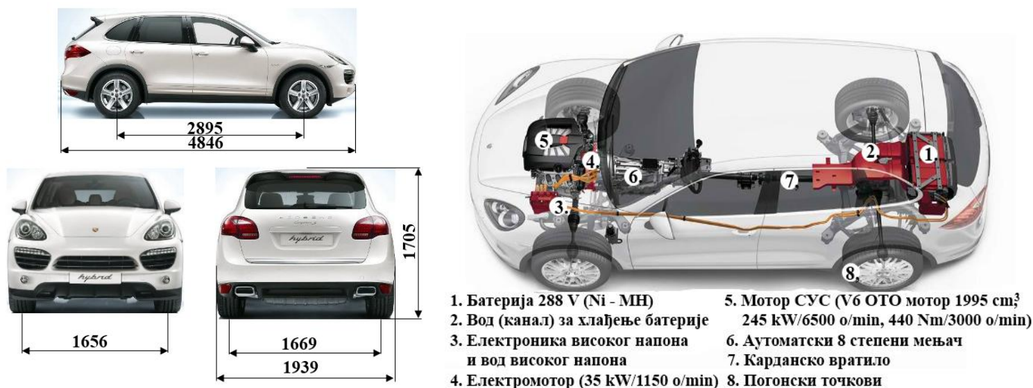
Слика 2.13 – Лево – Porsche Cayenne S Hybrid са основним димензијама; Десно – систем преноса снаге – трансмисија возила Porsche Cayenne S Hybrid [27] [28]
