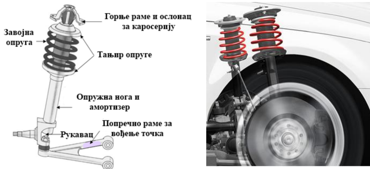
Слика 7.10 – Лево – Опружна нога система еластичног ослањања McPherson, Десно – Систем ослањања McPherson, код возила Audi A3 Sportback e – tron (PHEV) [42] [43]
