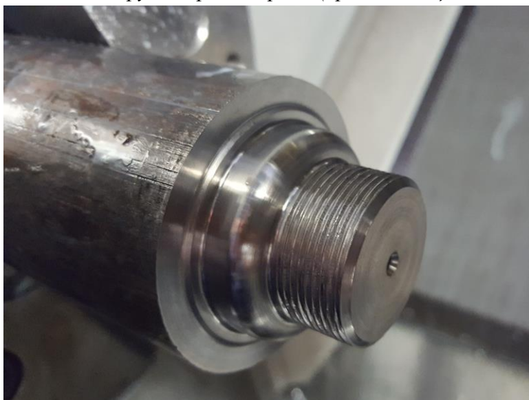
Слика 6.3.5. Израда навоја и забушивање
