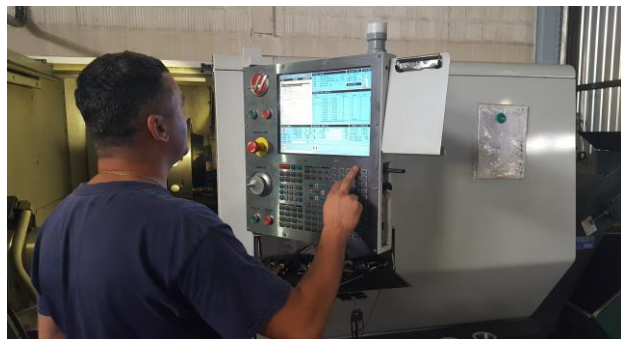
Слика 6.3.1. Подешавање програма за управљачку јединицу
