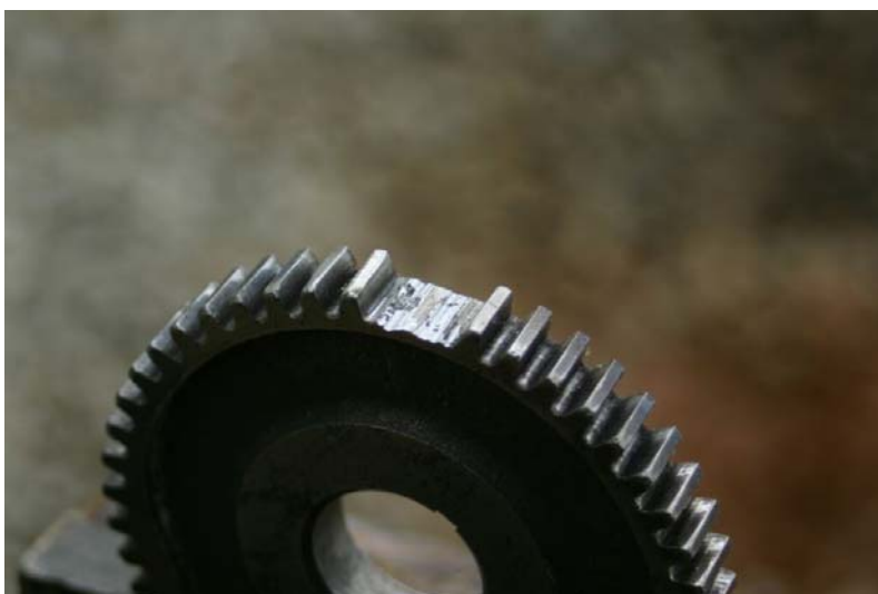
Слика 18. Изглед зупчаника након чишћења и брушења
