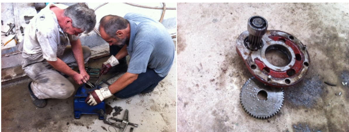
Слика 9. Операција демонтаже односно расклапања
