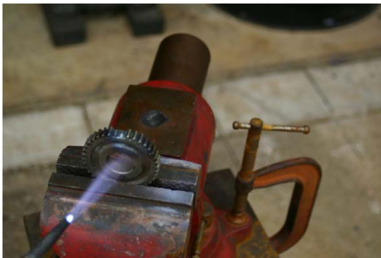
Слика 19. Предгревање зупчаника
