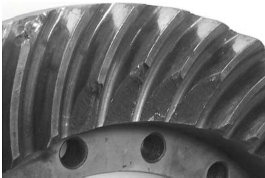
Слика 8. Заморни лом због савијања
