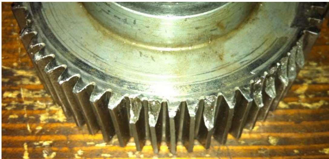
Слика 13. Изглед оштећеног венца зупчаника
