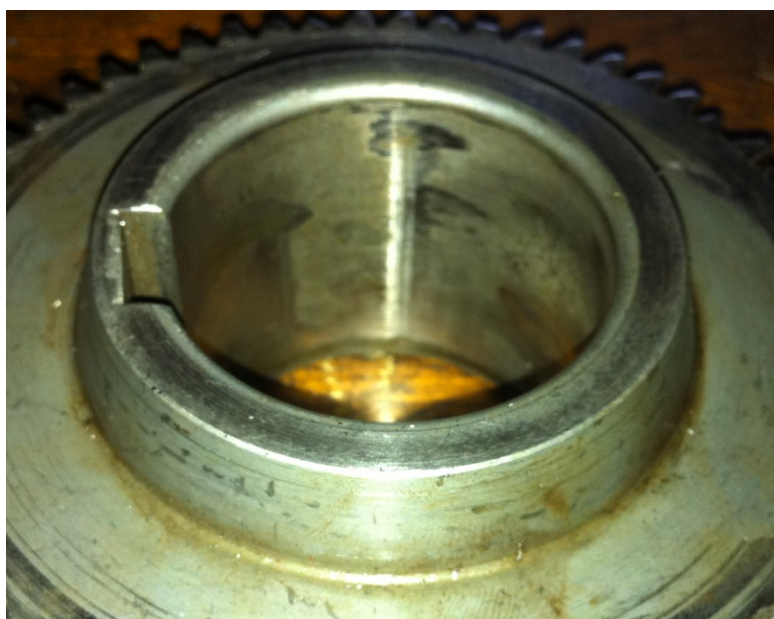
Слика 12. Изглед оштећене главчине зупчаника
