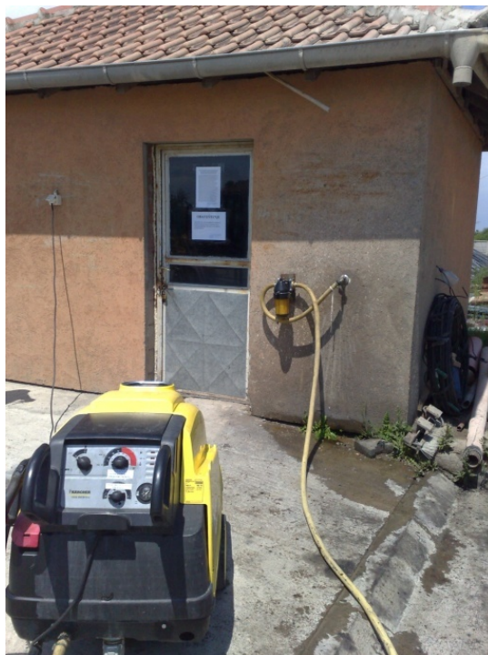
Слика 11. Уређај за прање и одмашћивање
