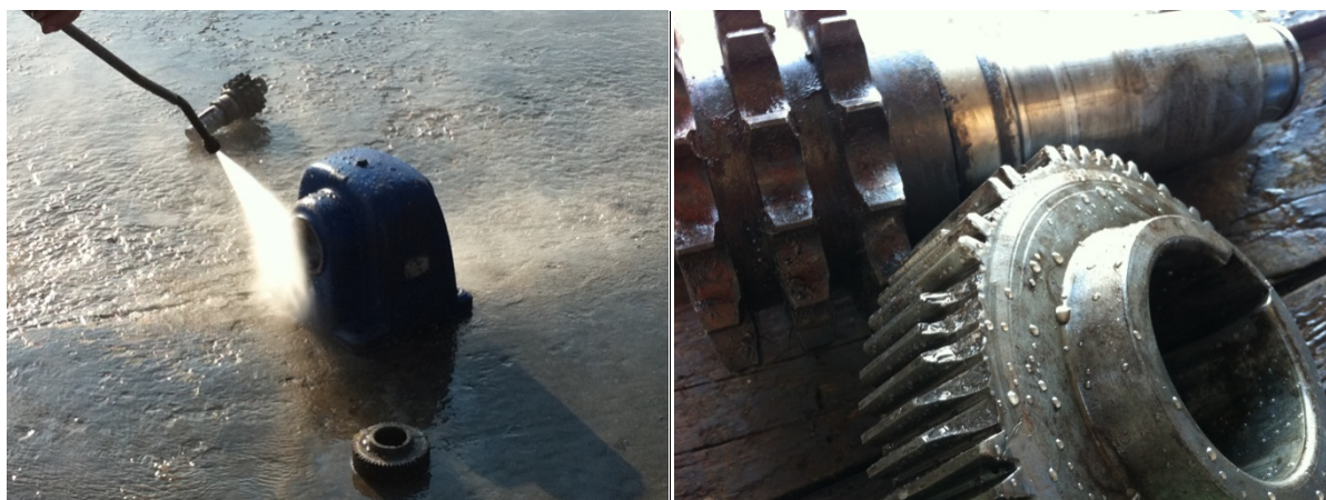
Слика 10. Чишћење, прање и одмашћивање узорака
