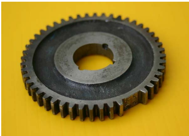
Слика 17. Изглед оштећеног зупчаника
