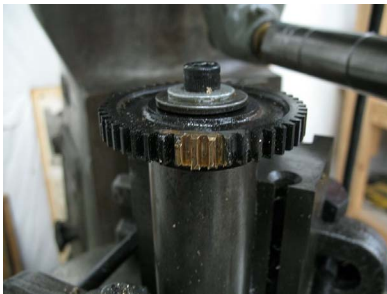
Слика 24. Изглед зупчаника након свих механичких и термичких обрада
