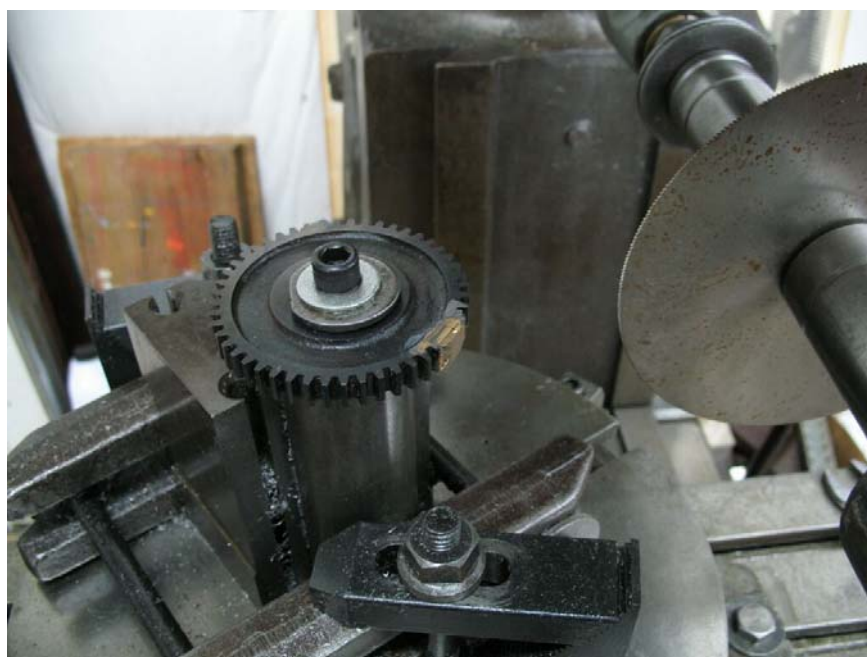
Слика 22. Усецање зубаца зупчаника
