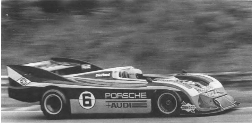
Слика 25. Тркачки аутомобил - Porsche 917/30, 1973; 809kW (1100ks), 370km/h c_D = 0.57
