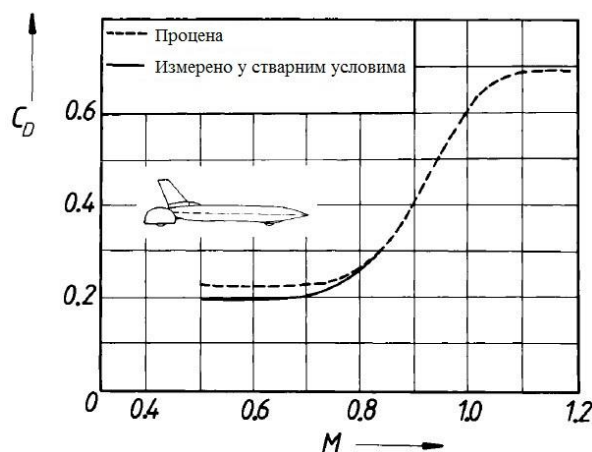
Слика 43. Повећање коефицијента отпора "Плавог Пламена" у зависности од Маховог броја [21]
