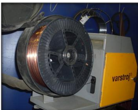
Слика_5.15 Намотај пуњене жице на уређају за заваривање МАГ поступком [8].
