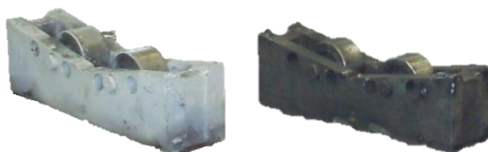
Слика_6.3 Ваљци за ослањање цеви добоша [8]
