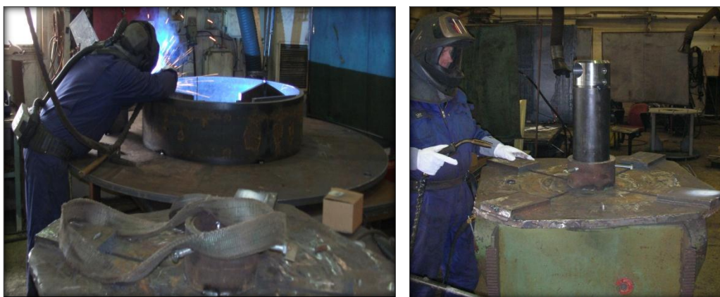
Слика_2.3 Приказ заваривања цилиндричних делова великих габарита
