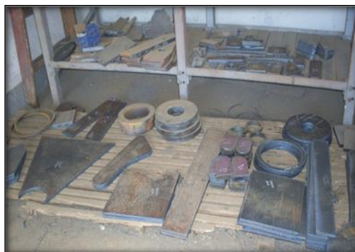
Слика_5.9 Делови исечени на CNC машини [8]
