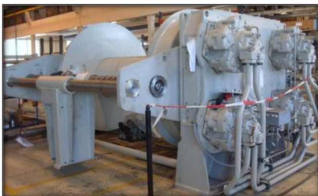
Слика_3.5 Витла са вратилом за правилно усмеравање сајле (ужета) [8]
