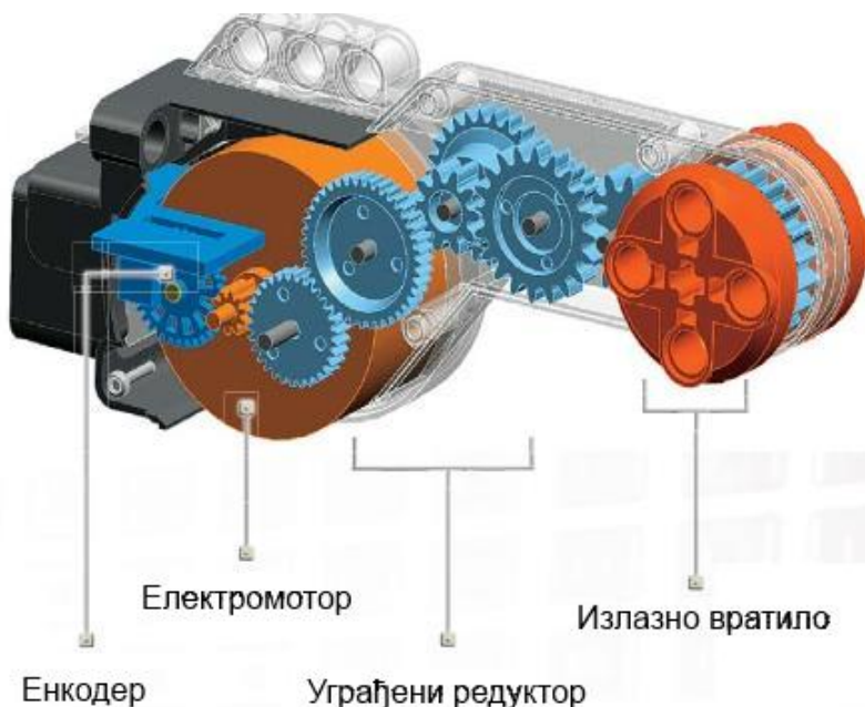
Слика 2. Цртеж унутрашњости Лего мотора [1]
