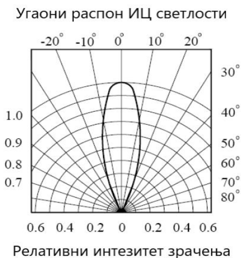
Слика 9. Интензитет зрачења ИЦ диоде „5 mm Round Infrared Chip LED T-1 3/4“
