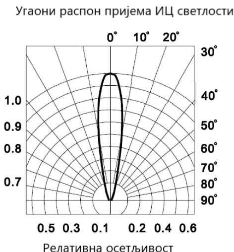
Слика 13. Осетљивост фототранзистора „LTR-4206E“
