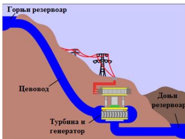
Слика 2.2.2.2 - Шема реверзибилне хидроелектране [9]
