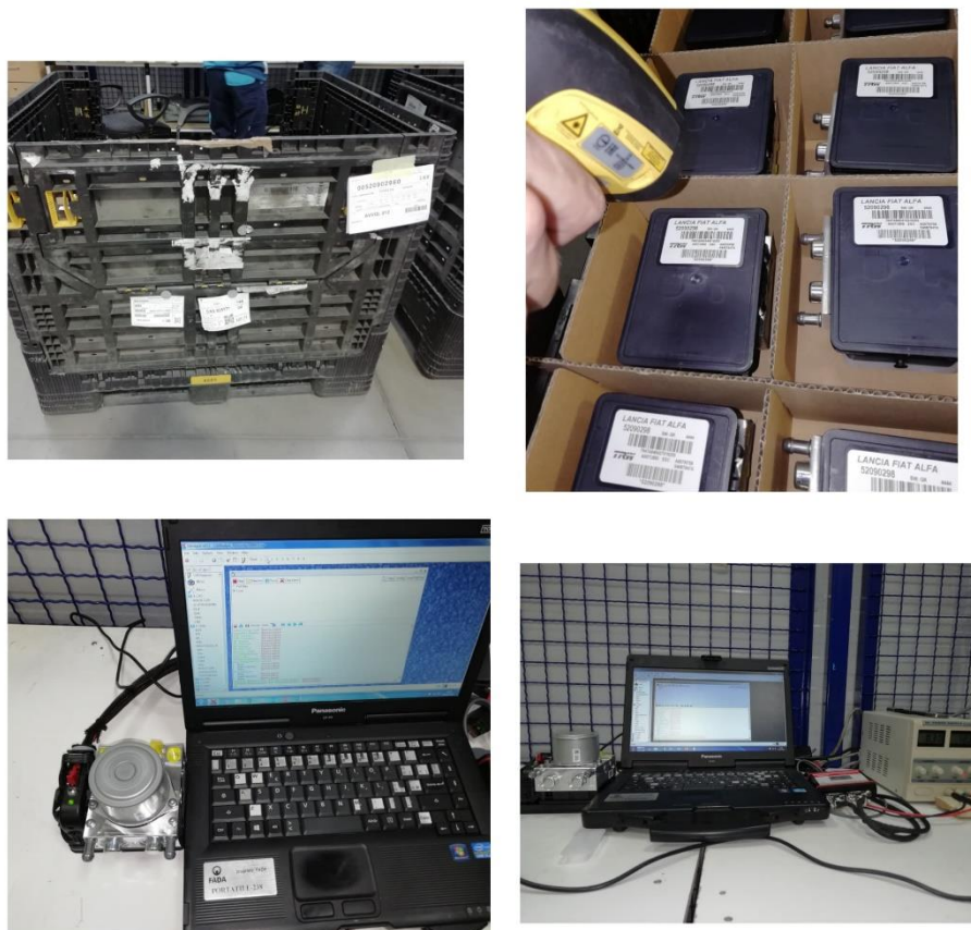
Слика 9. Почетна операција контроле АБС централине
