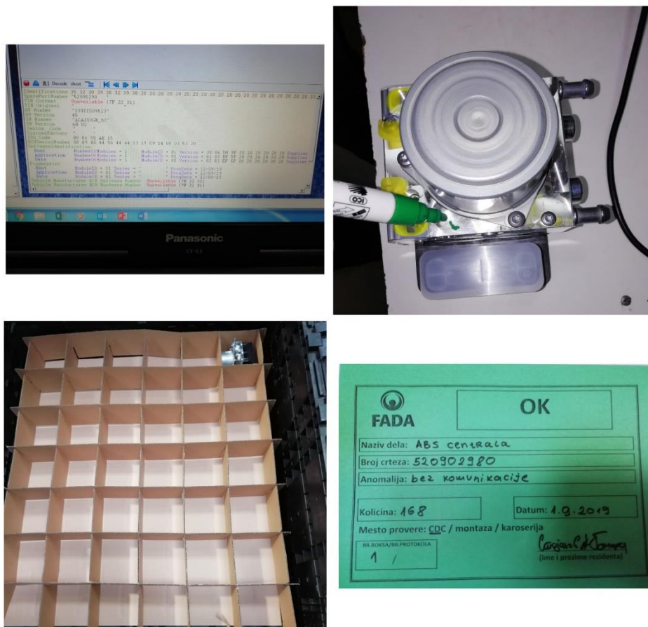
Слика 10. Завршна операција контроле АБС централине
